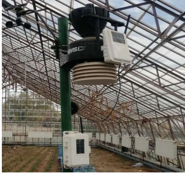
Şekil 3.2. Sera içi iklim ölçümlerinin yapıldığı portatif iklim istasyonu (Davis Vantage Pro2)
