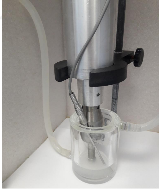
Şekil 2. 9: Ultrasonik ekstraksiyon aşaması
