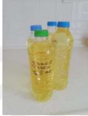
Şekil 5.12. %47,5 Biyodizel %47,5 Dizel %5 n-Bütanol Yakıt Karışımı
