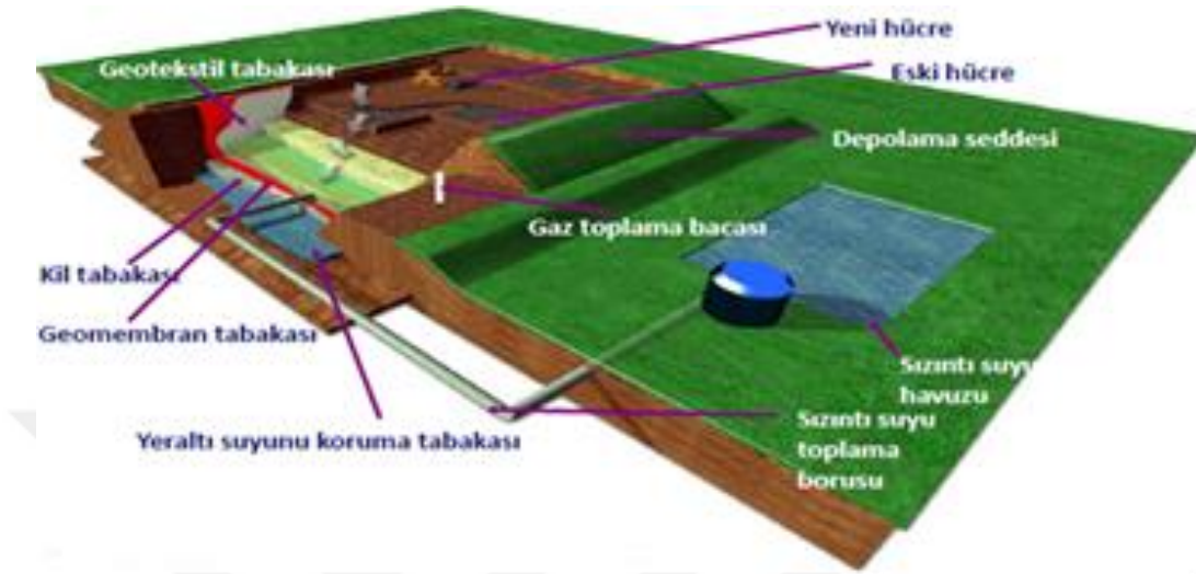
Şekil 1.9. Bir atık düzenli depolama tesisi yapısı
