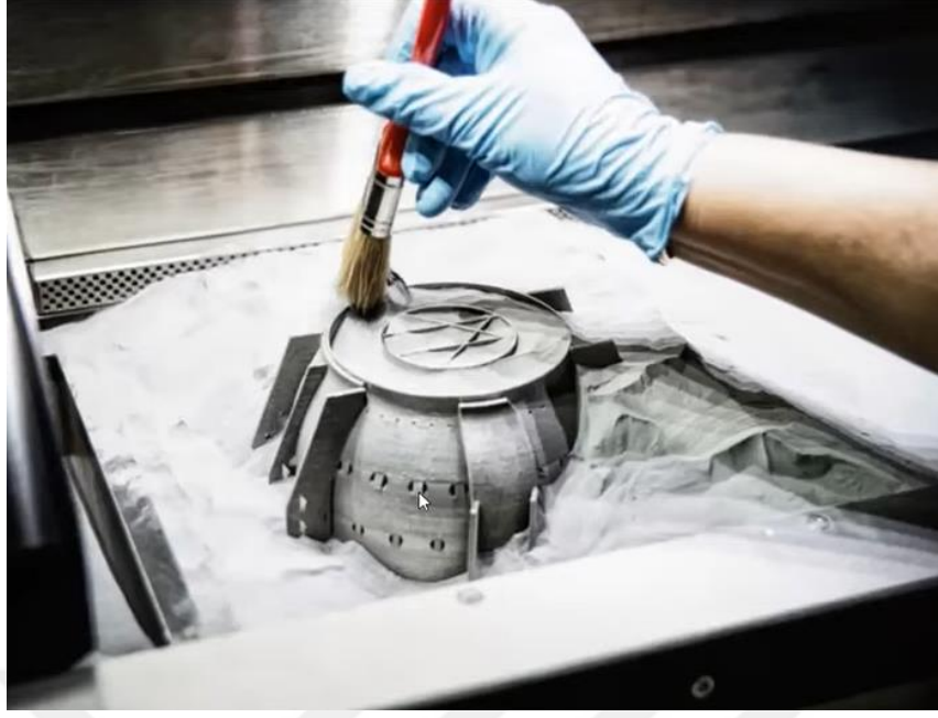
Şekil 4.3. SLM ile üretilmiş ve TJ90 turbojet motoruna ait bir parça.
