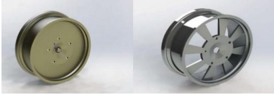
Şekil 3.7. Optimize edilmemiş ve edilmiş jant tasarımı.
