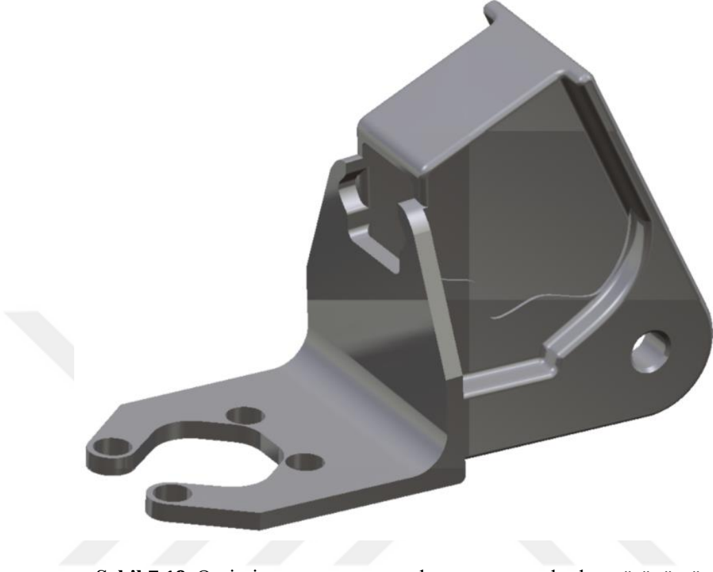
Şekil 7.18. Optimizasyon sonrası malzeme atanmış braket görünümü.
