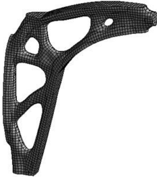
Şekil 3.10. Topoloji optimizasyonu sonrası kontrol kolu.
