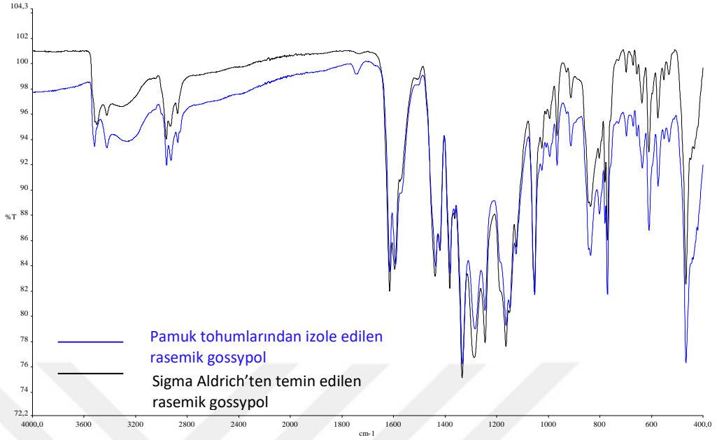
Şekil 4.2. Satın alınan referans gossypol (siyah) ile tarafımızca izole edilen gossypol (mavi) bileşiklerinin FT-IR spektrumları
