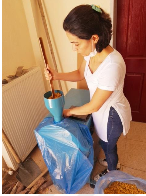
Şekil 3.2. Kurutulan katırtırnağı çiçeklerinin değirmende öğütülmesi
