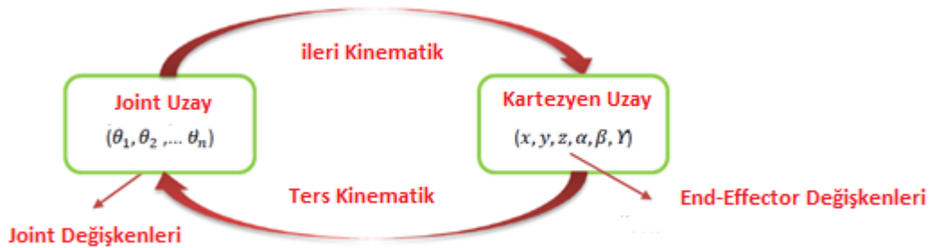
Şekil 3.4. İleri ve ters kinematik bağlantısı.
