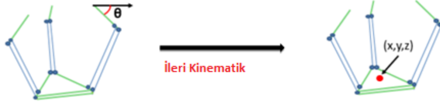
Şekil 3.5. Delta robot ileri kinematik gösterimi.
