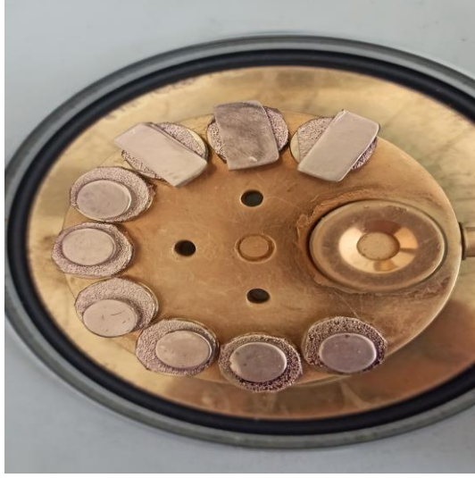
Şekil 2.25. SEM analizi için altın kaplanan örnekler.
