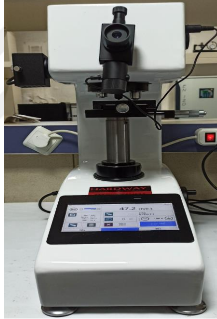
Şekil 2.17. Çalışmada kullanılan mikrosertlik cihazı (Hardway Microvickers, MHVS 1000AD, Türkiye).
