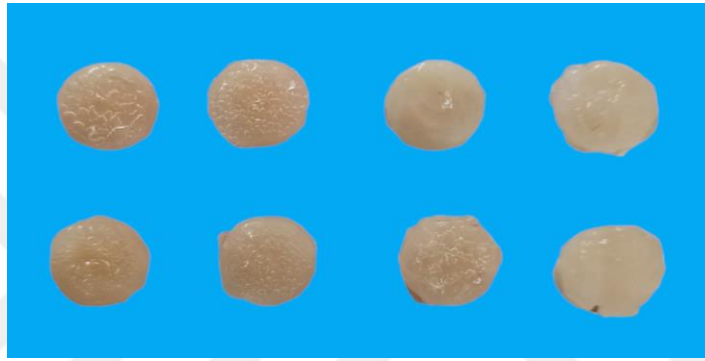
Şekil 2.20. Kompozit örneklere ev tipi beyazlatma ajanının uygulanması.
