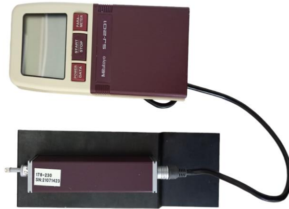
Şekil 2.16. Çalışmada kullanılan yüzey pürüzlülüğü ölçüm cihazı (Mitutoyo SJ-301, Tokyo, Japonya)
