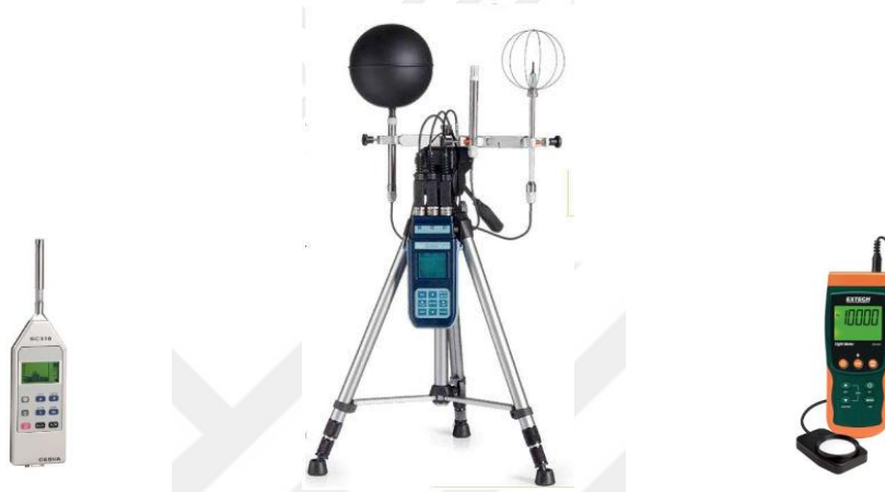
Resim 3.1. Gürültü ölçüm cihazı, mikro klima analiz cihazı, aydınlık şiddeti ölçüm cihazı
