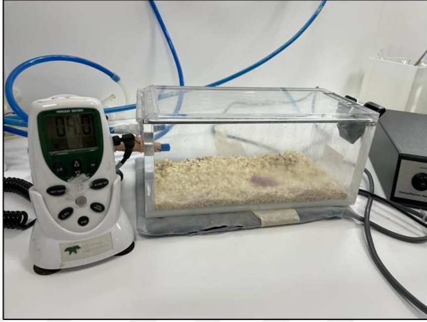
Şekil 5.2.1.3. %9 O 2 ve %91 N 2 olan yenidoğan hipoksi çemberi ünitesi.
