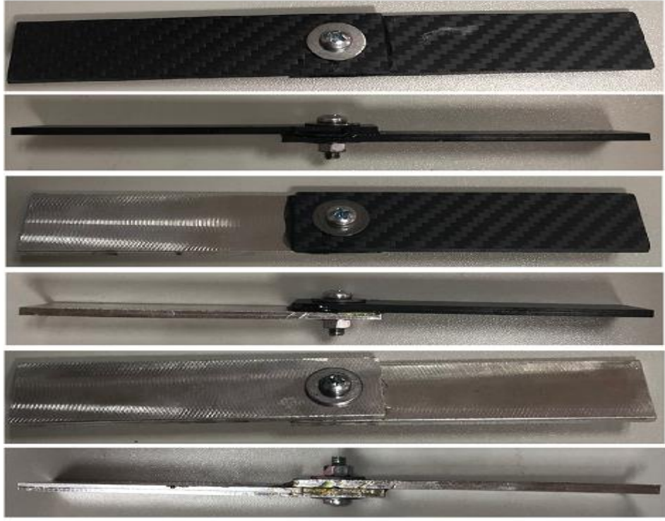
Şekil 14. AZ91-AZ91, AZ91-karbon fiber ve karbon fiber-karbon fiber civatalı-yapıştırırmalı tek bindirmeli plaka numunelerinin görüntüleri
