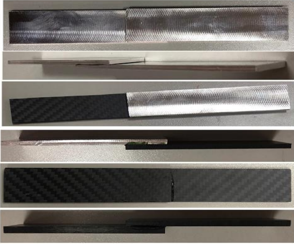
Şekil 12. AZ91-AZ91, AZ91-karbon fiber ve karbon fiber-karbon fiber yapıştırırmalı tek bindirmeli plaka numunelerinin görüntüleri
