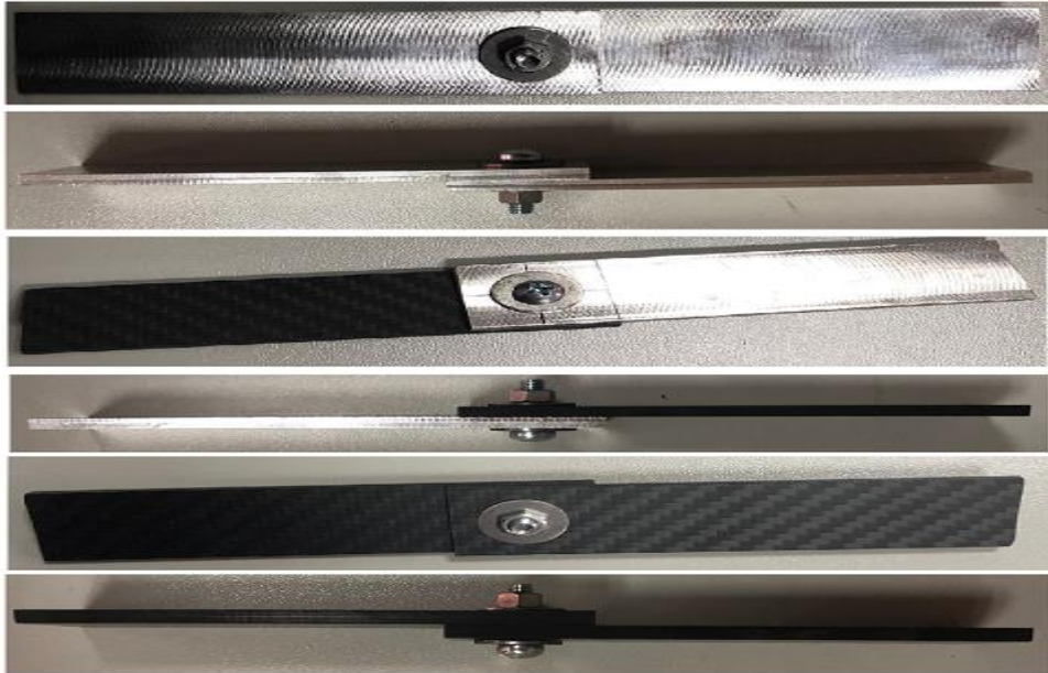
Şekil 13. AZ91-AZ91, AZ91-Karbon fiber ve karbon fiber-karbon fiber civatalı tek bindirmeli plaka numunelerinin görüntüleri
