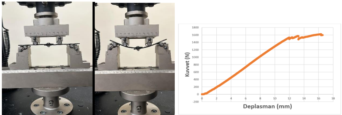
Şekil 31. KF-KF civatalı tek bindirmeli plaka bağlantısının dört nokta eğme test öncesi ve sonrası görüntüsü ve kuvvet-deplasman grafiği
