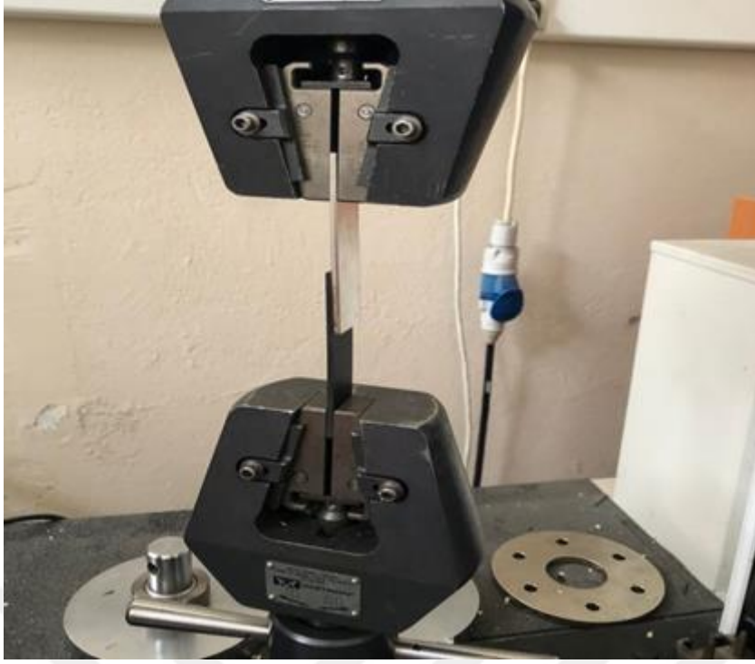
Şekil 15. Çekme testi gösterimi
