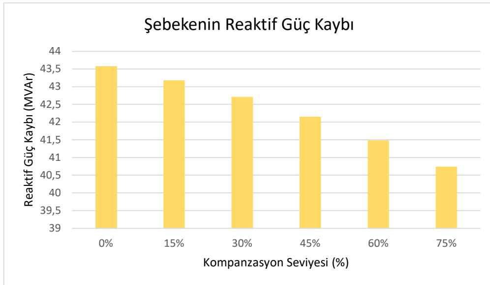
Şekil 35. Kompanzasyon seviyesine göre şebekenin reaktif güç kaybı
