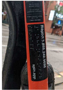
Şekil 3.27 Görme engelliler için kabartma harfler (CDOT, 2019)
