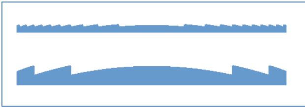
Şekil 2.5. Farklı adım boyutlarıyla, aynı odak uzaklığına sahip iki Fresnel lens
