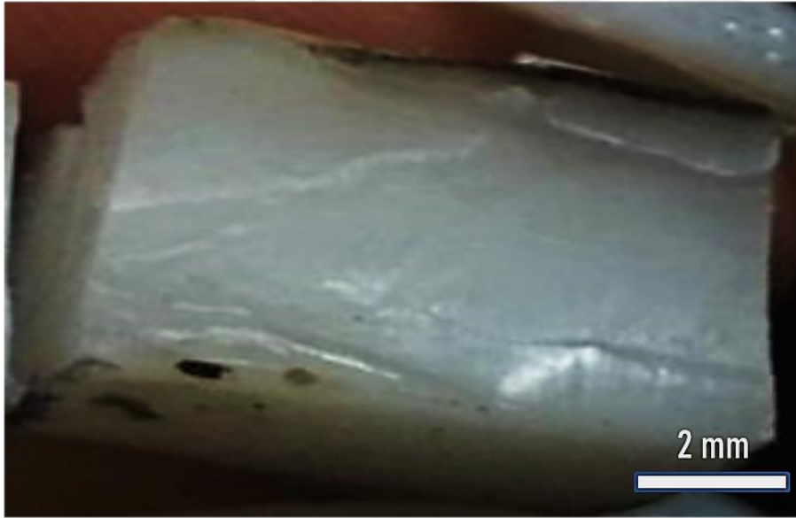
Resim 5.8. Charpy darbe testi sonrası kaynaklı numunede kırılma bölgesi
