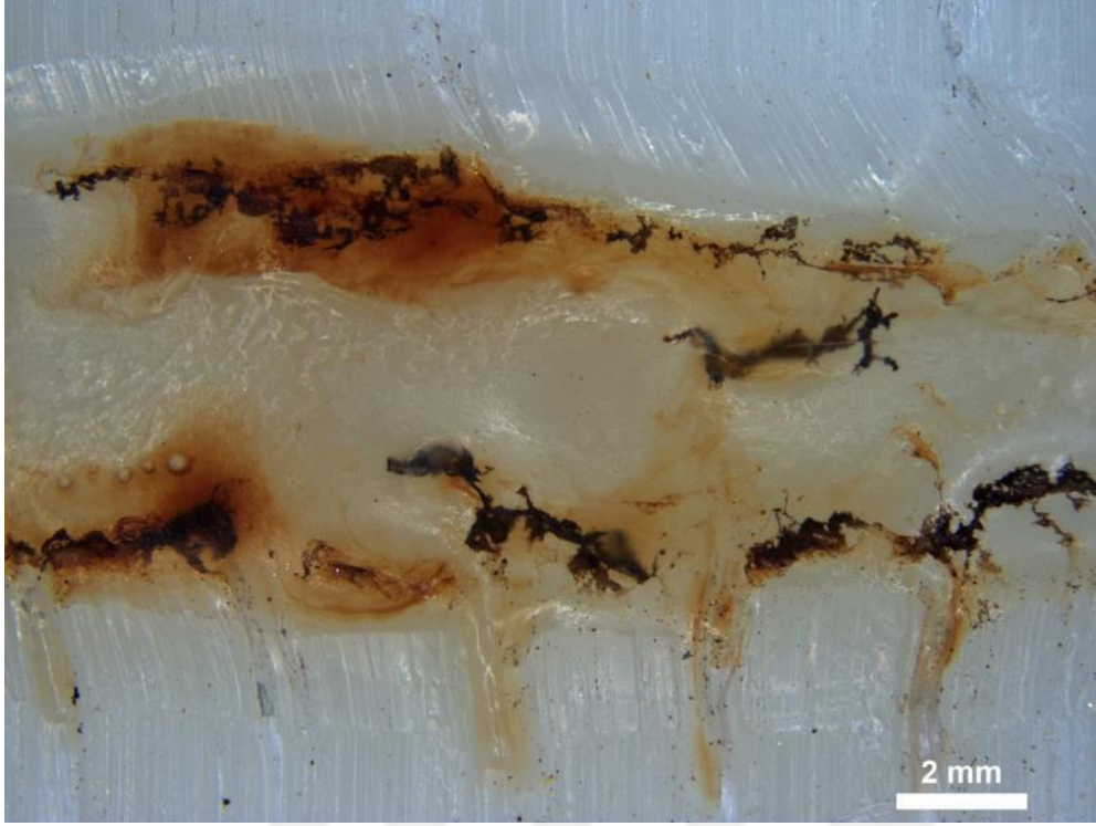
Resim 5.3. 1 numaralı numunenin kaynak bölgesi ön yüzü
