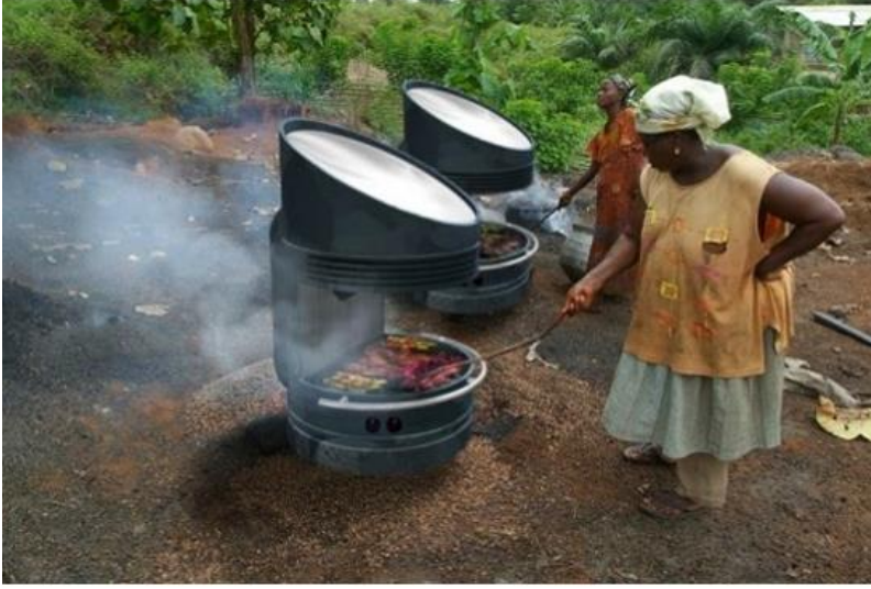
Resim 2.11. Fresnel lensler ile yemek pişirmek
