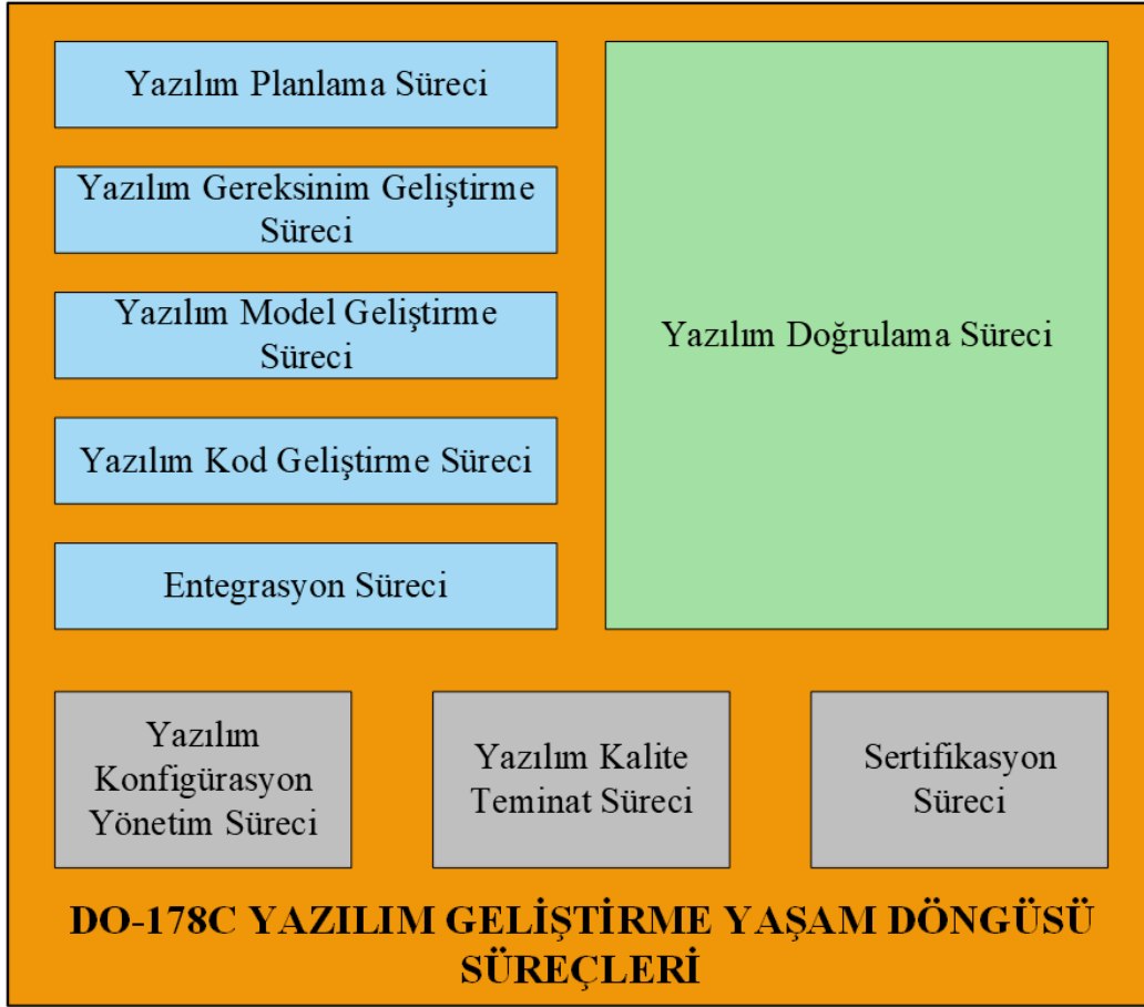
Şekil 2.2 DO-178C yazılım geliştirme yaşam döngüsü süreçleri
