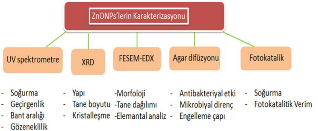
Şekil 3.2 ZnONPs'lerin karakterizasyonunda kullanılan teknikler ve incelenen özellikler
