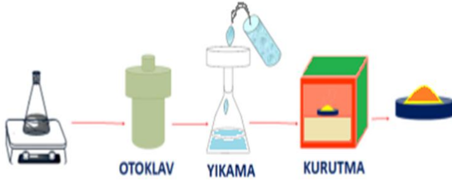
Şekil 1.10 Hidrotermal sentez yönteminin şematik gösterimi
