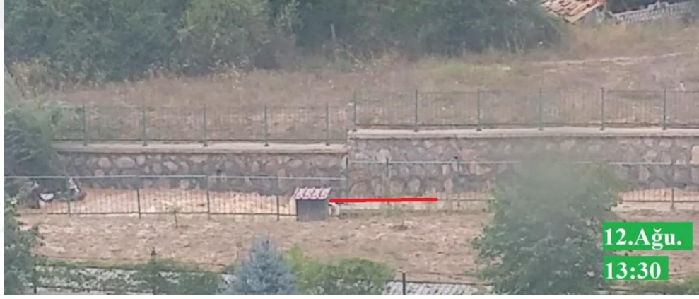
Şekil 4.20. Sağanağın başlangıcından 41 saat sonra kesitte gözlenmiş su seviyesi
