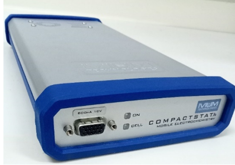
Şekil 38. İvium CompactStat.h10800 markalı elektrokimyasal ölçüm cihazı
