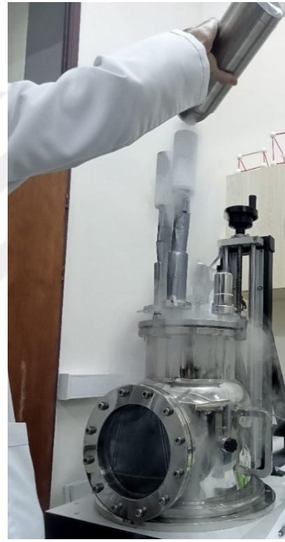
Şekil 36. Sisteme sıvı azot eklenmesi
