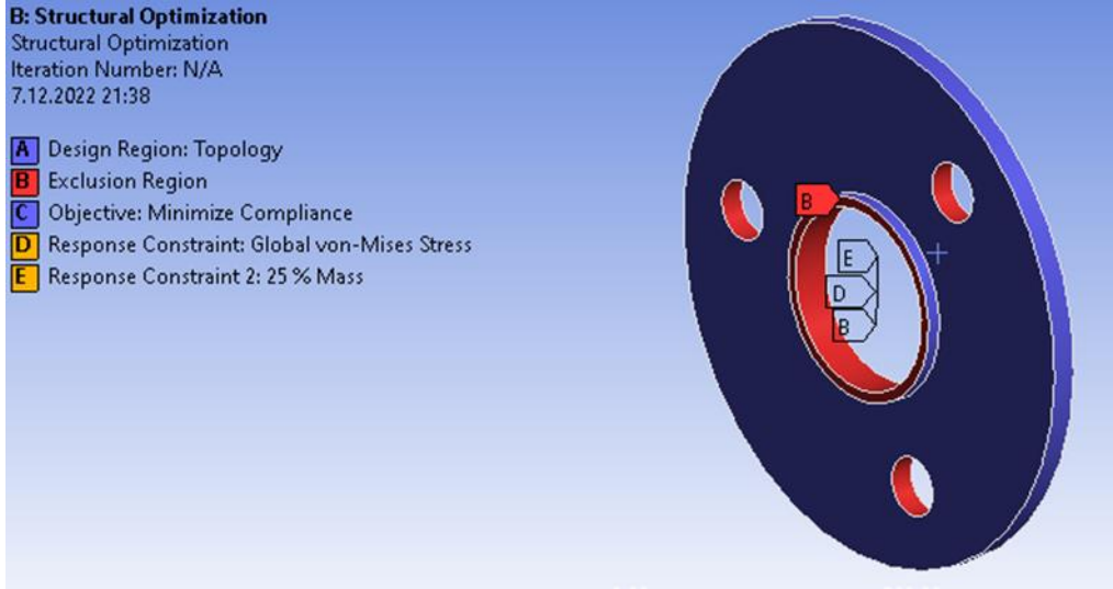
Şekil 4.6 Planet kolu topoloji analizi sınır şartları
