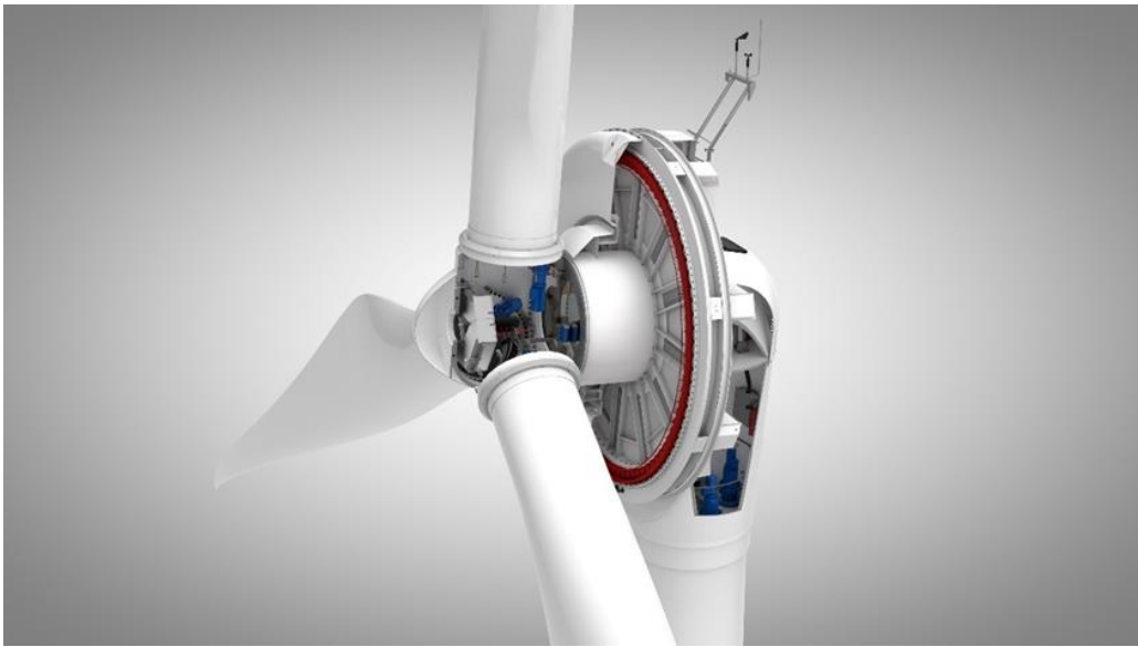
Şekil 2.13 Doğrudan tahrikli bir rüzgar türbininin jeneratörü
