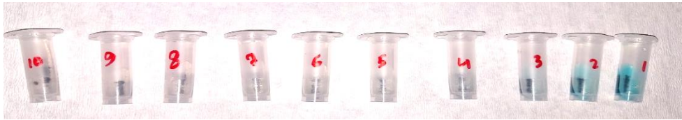
Şekil A.1 Ön işlemsiz \text{NaHCO}_3 metilen mavisi gideriminde denge zamanı (1-10dk)
