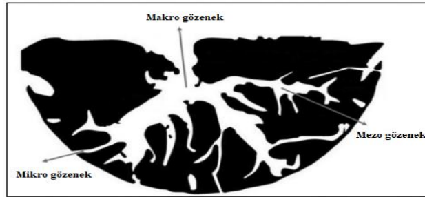
Şekil 3.1 Aktif karbonun gözenek yapısının şematik gösterimi [12]
