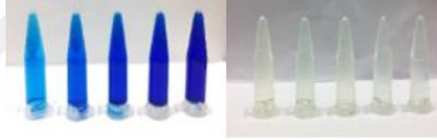
Şekil 6.2 Metilen mavisinin öncesi ve sonrası (24 saat) renk değişimi [78]
