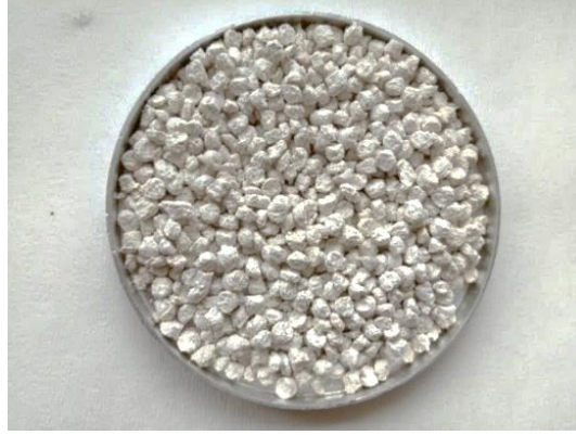
Şekil 3.4 Üre ile zenginleştirilmiş ve granül hale getirilmiş nano hidroksiapatitin görüntüsü
