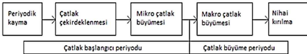
Şekil 2.17 Yorulma Çatlak Oluşum Aşamaları (Efe 2018).
