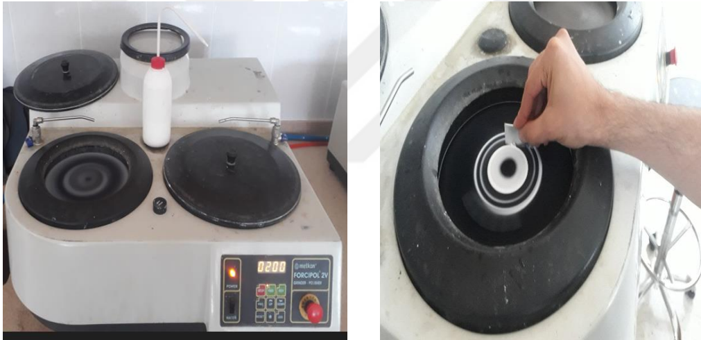
Resim 3.12 Numune Parlatma Cihazı ve Numune Kesit Yüzeylerinin Parlatılması.
