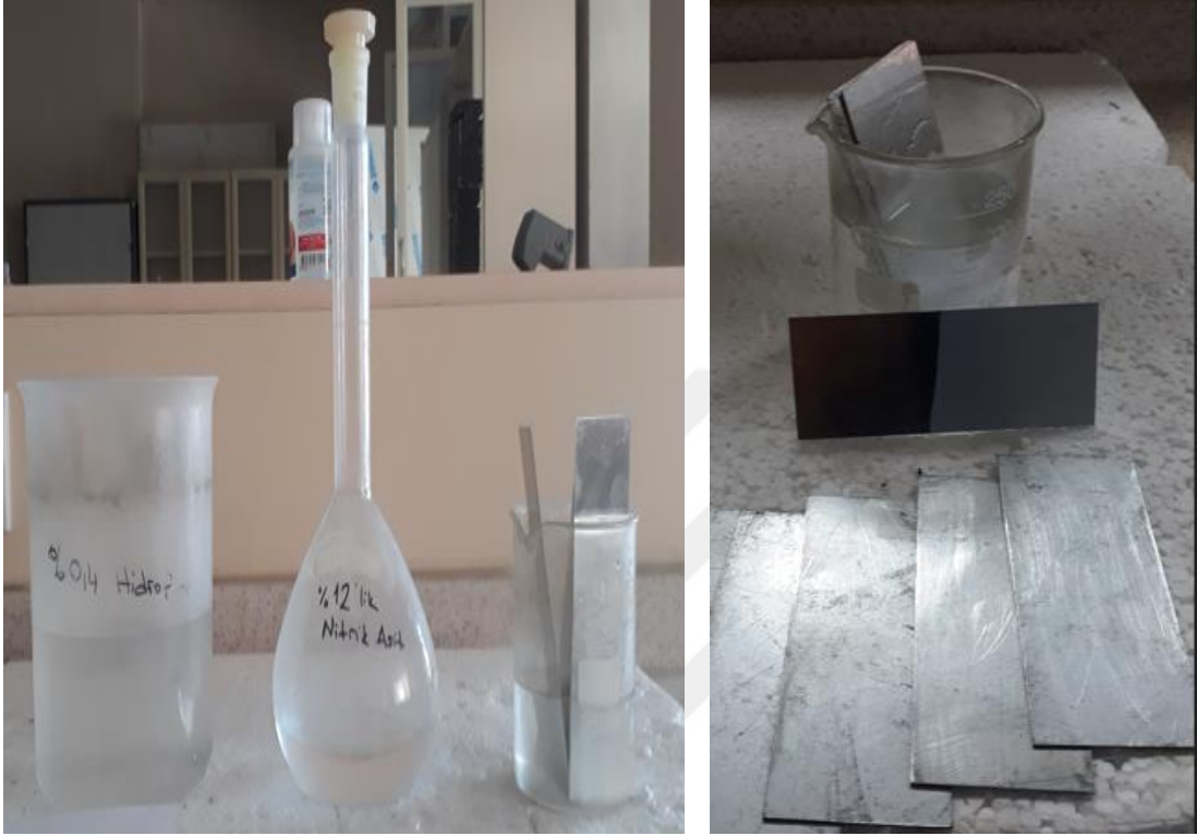
Resim 3.2 Al 5052 Alaşımı Sac Levha Numunelerinin Yüzeylerindeki Oksit Tabakalarının Giderilmesi.
