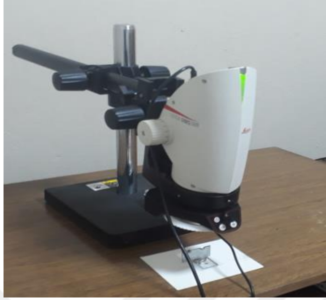
Resim 3.13 Leica DMS 300 Dijital Mikroskop ile Numune Kesit Görünüş İncelenmesi.
