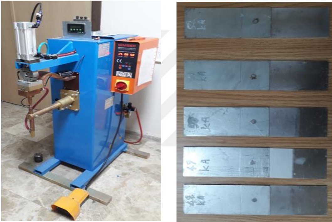
Resim 3.3 Elektrik Direnç Kaynağı Makinesi ve EDK ile Birleştirilmiş Numuneler.
