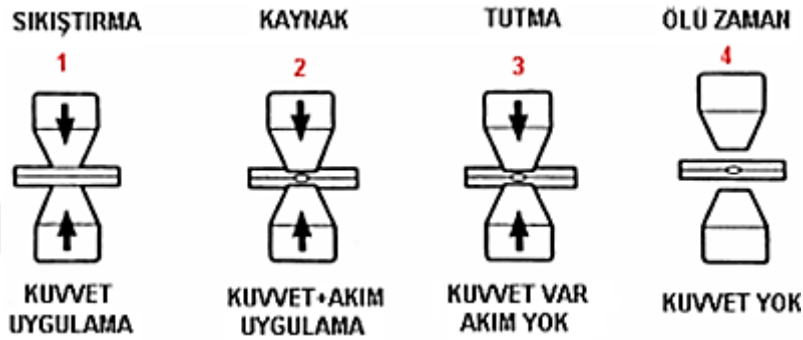
Şekil 2.24 Nokta Direnç Kaynağı Uygulama Aşamaları (Yeşildal 2008).
