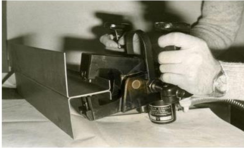
Resim 2.3 1982 Senesinde Üretimi Gerçekleştirilmiş İlk Form Punta Pensesi (Çetkin 2010).
