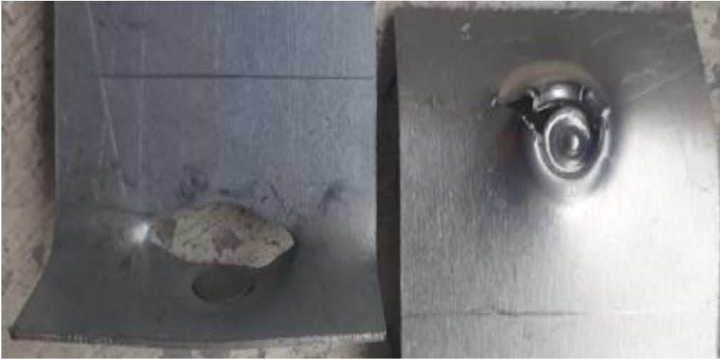
Resim 4.7 KDP Metot ile Birleştirilen Numunelerde Yorulma Hasarları.
