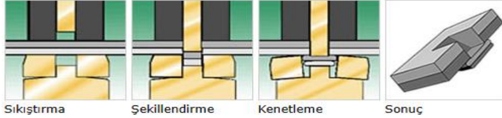
Şekil 2.35 Dikdörtgen Birleştirme Tipi (İnt. Kyn. 8).
