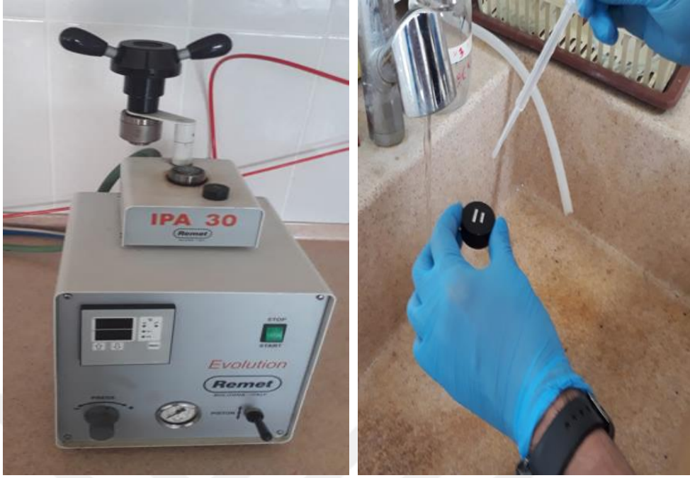
Resim 3.14 Sıcak Bakalite Alma Cihazı ve Numune Dağlama İşlemi.
