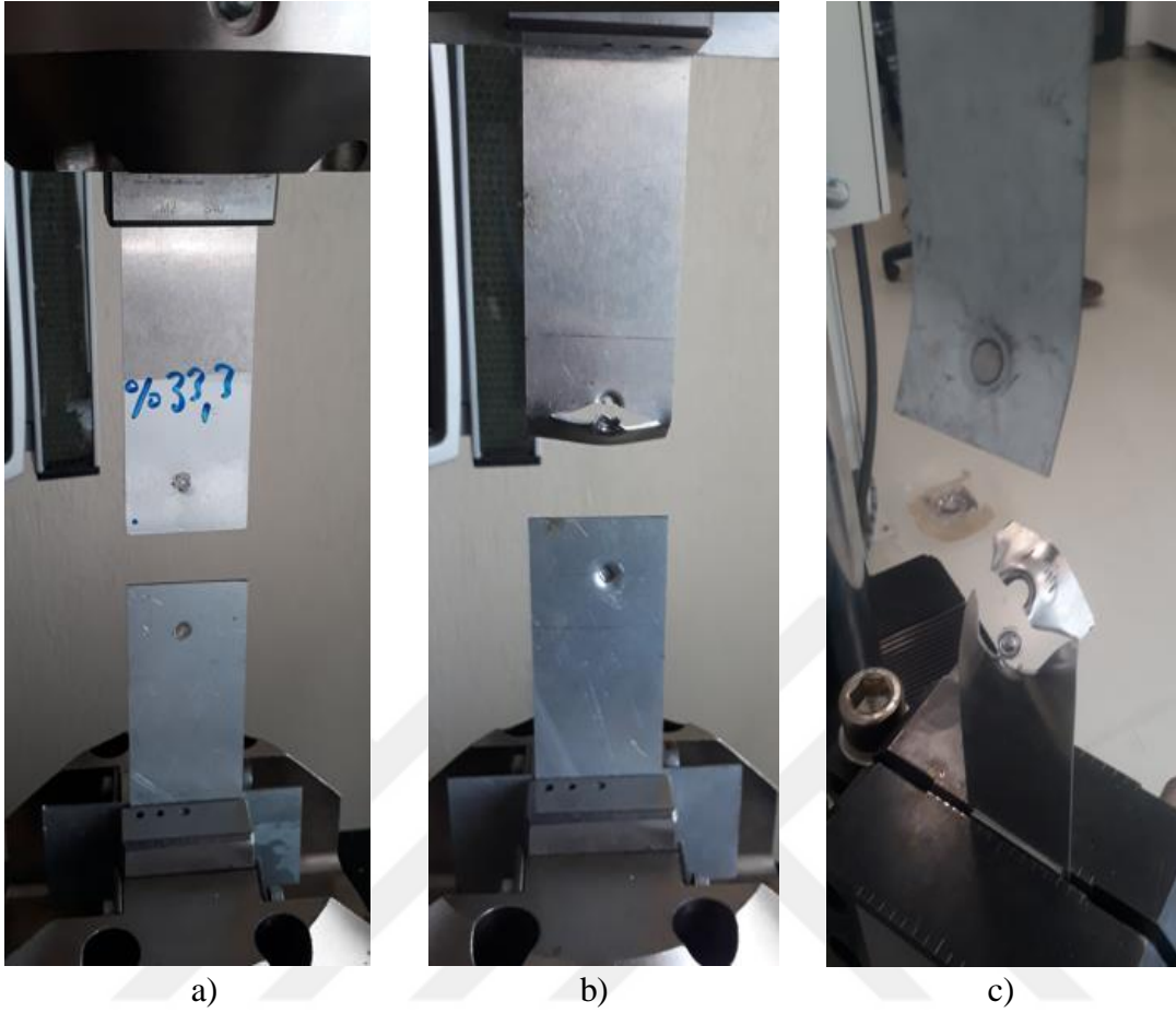
Resim 3.10 TSE EN ISO 14324 Standartlarında Birleştirilmiş Yorulma Deneyi Numuneleri a) EDK Metot b) Form Punta Metot c) KDP Metot.
