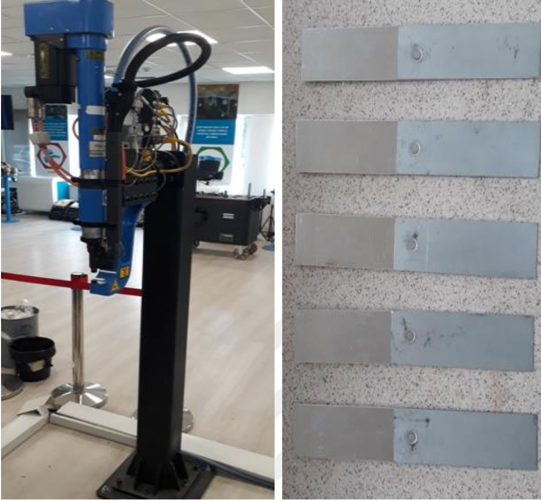
Resim 3.6 KDP Makinesi ve KDP ile Birleřtirilen Deney Numuneleri.
