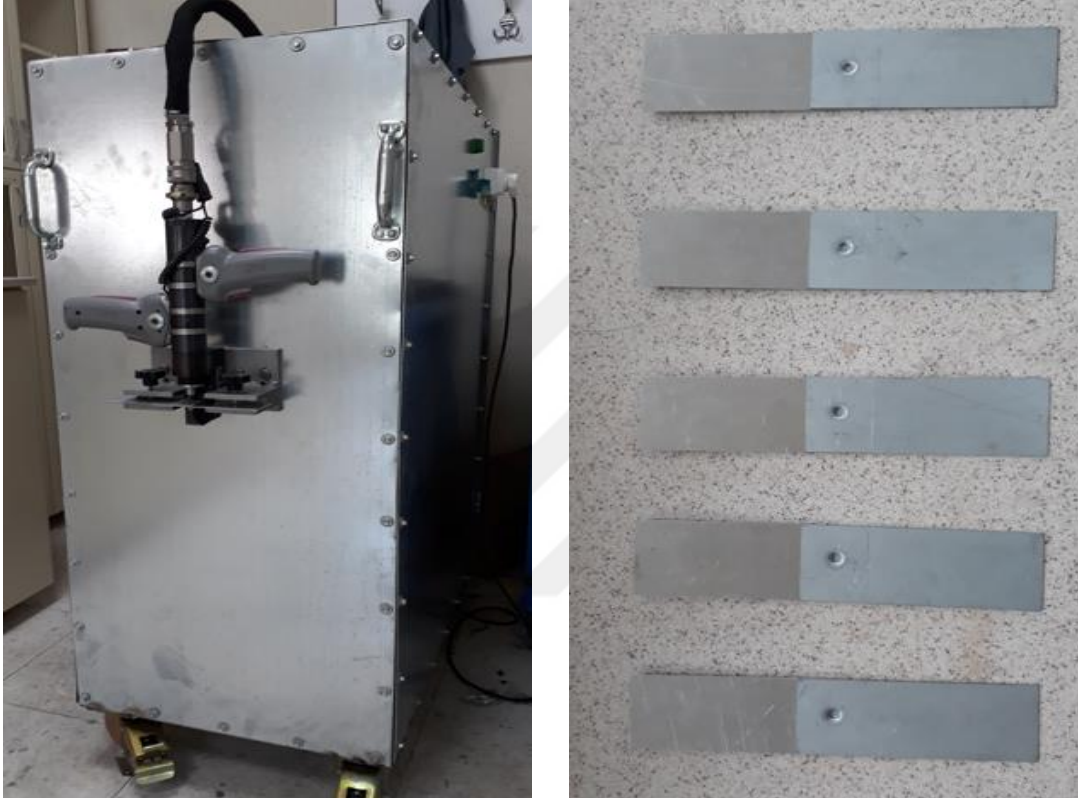
Resim 3.4 TOX Form Punta Makinesi ve Form Punta Metot ile Birleřtirilen Deney Numuneleri.
