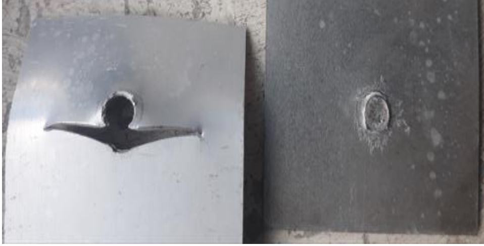
Resim 4.5 EDK Metot Yorulma Hasarları a) Arayüz Hasar Modu b) Çekme Hasar Modu c) Levha Yırtılma Modu.
