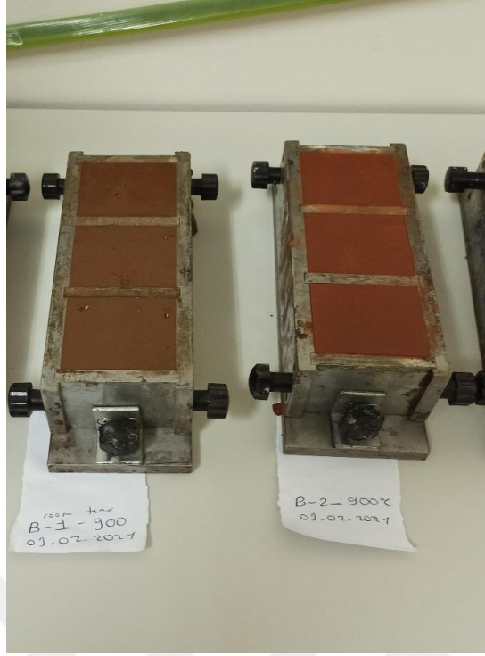
Şekil 9. Kalıplara dökülmüş geopolimer örnekleri.
