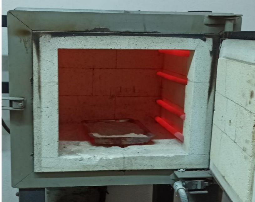
Şekil 7. Başlangıç malzemesinin 900^\circ\text{C} 'de kalsinasyon işlemi.
