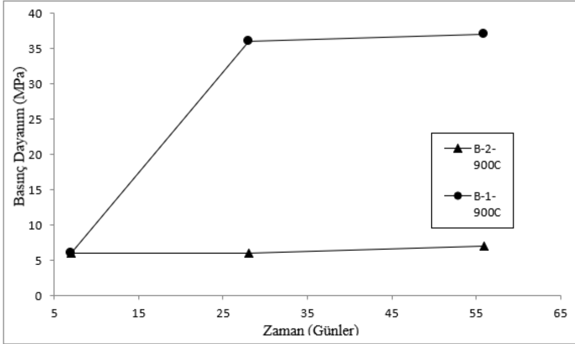
Şekil 17. B-1-900°C ve B-2-900°C örneklerinin 7, 28, 56 günlük basınç dayanımları.
