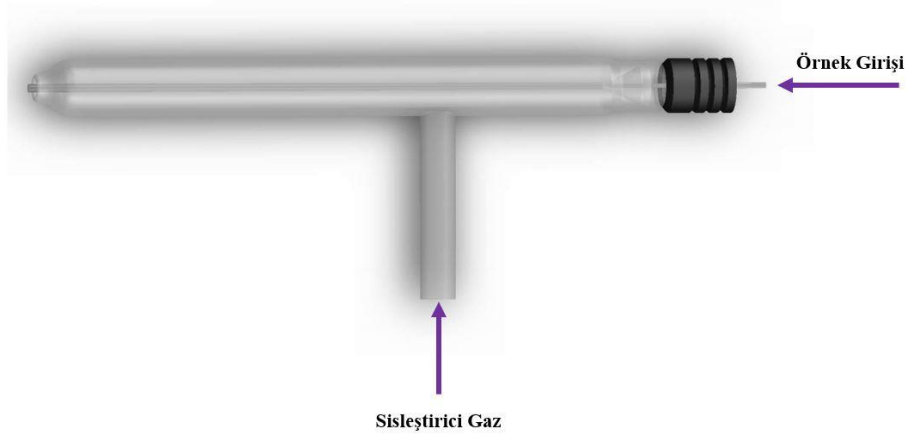
Şekil 2. 5 Nebulizatörün şematik gösterimi.
