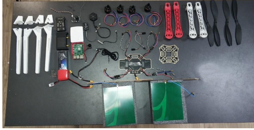
Şekil 3.11. İHA üzerindeki tüm eleman ve komponentler
