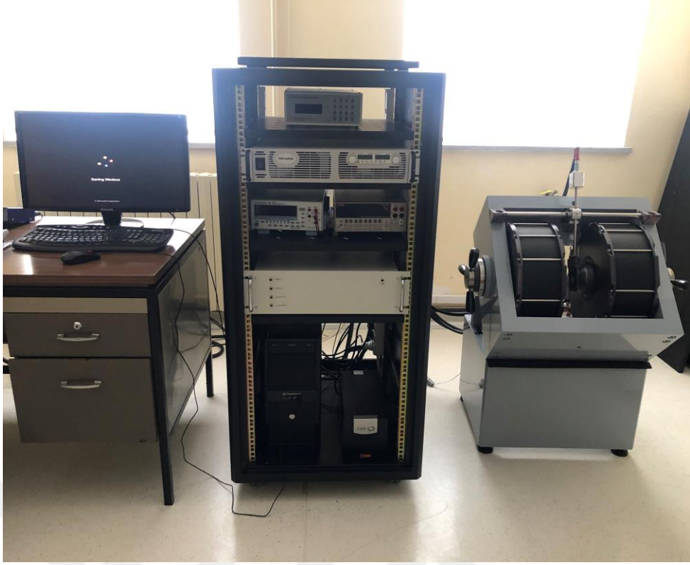
Şekil 5. 10 Sivas Cumhuriyet Üniversitesi Nanofotonik Uygulama ve Araştırma Merkezi bünyesinde kurulu bulunan Hall ölçümü sistemi.
