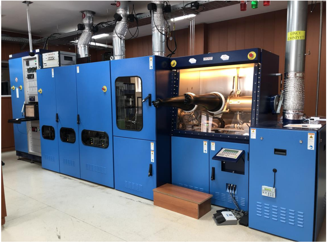
Şekil 5. 3 Sivas Cumhuriyet Üniversitesi Nanofotonik Uygulama ve Araştırma Merkezi'nde kurulu olan AIXTRON 200/4 RF-S model MOVPE büyütme sistemi.
