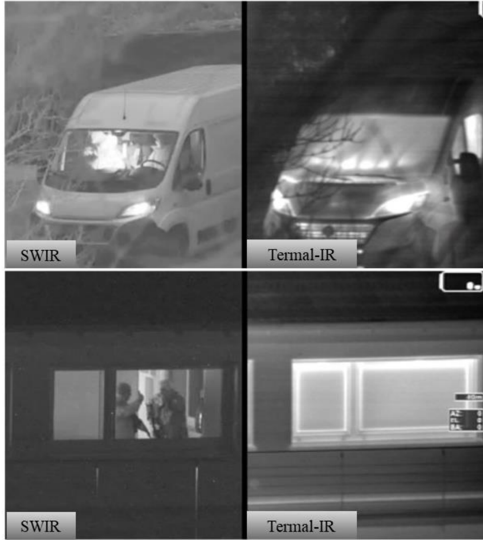
Şekil 3. 9 Gece bir cam arkasından alınan MWIR termal kamera ve SWIR kamera görüntüleri [32].
