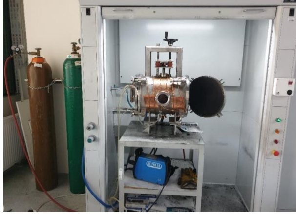
Şekil 2.1 : FLG üretiminin gerçekleştirildiği reaktör.
