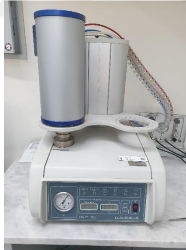
Şekil 2.23 : Linseis Sta Pt 1600 marka diferansiyel termal analiz cihazı (DTA).
