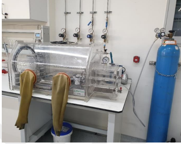
Şekil 2.4: Tozların inert ortamda hazırlanması için kullanılan kapalı ortam kutusu (glove box).
