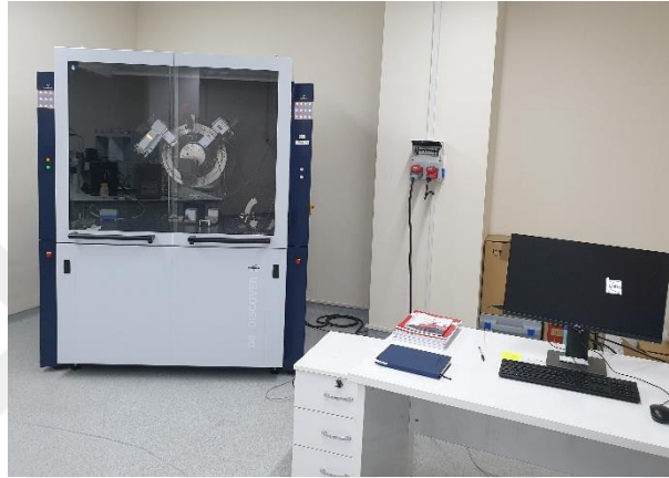
Şekil 2.24 : Bruker AXS/Discovery D8 marka X - Işınları difraktometresi.
