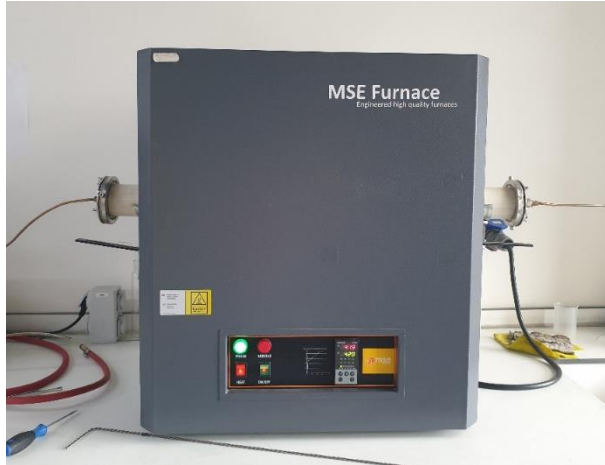
Şekil 2.12 : Bağlayıcı giderme işleminin yapıldığı MSE T-1600-74-450 marka tüp fırın.
