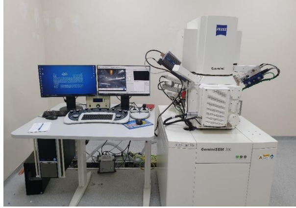
Şekil 2.25 : Carl Zeiss / Gemini 300 marka taramalı elektron mikroskobu.
