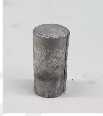
Şekil 2.37 : (a) Shimadzu™ AG-X marka mekanik test cihazı, (b) basma testi numunesi.
