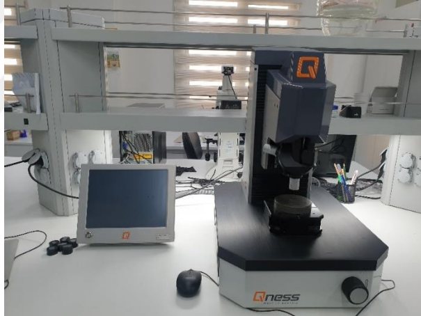
Şekil 2.32 : Qness Q10M marka sertlik cihazı.
