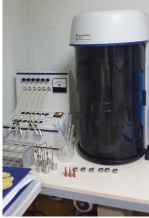
Şekil 2.21 : Micrometrics™ Tristar II marka yüzey alanı ve gözenek boyutu analiz sistemi.
