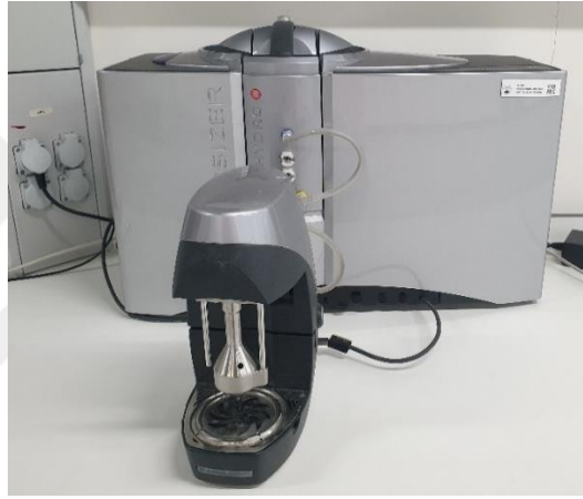
Şekil 2.20 : Malvern Mastersizer 3000 model partikül boyut cihazı.
