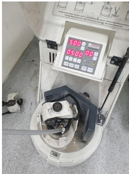
Şekil 2.5 : Öğütme işlemlerinin yapıldığı gezegensel tipli bilyalı öğütücü.
