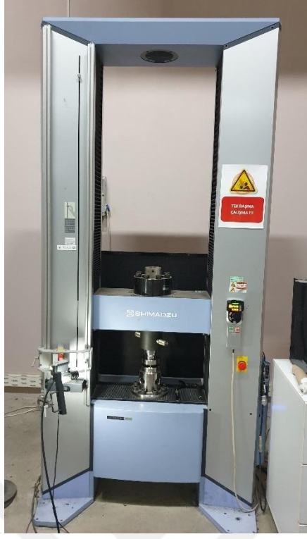
Şekil 2.37 : (a) Shimadzu™ AG-X marka mekanik test cihazı, (b) basma testi numunesi.
