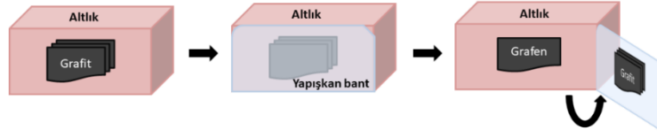
Şekil 1.5 : Grafenin mekanik eksfoliasyon ile üretiminin şematik gösterimi.
