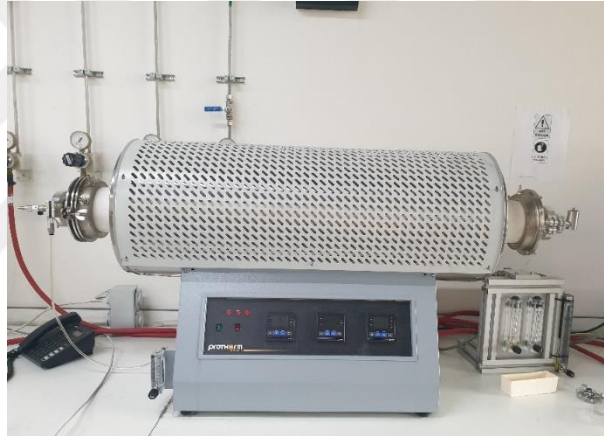
Şekil 2.14 : Sinterleme işleminin yapıldığı Protherm PZF12-105-900 marka tüp fırın.
