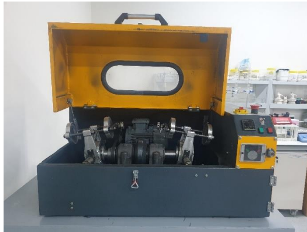
Şekil 2.7 : SPEX tipi yüksek enerjili bilyalı öğütücü.
