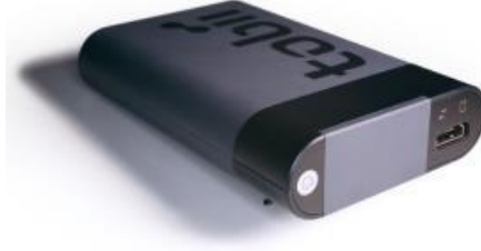
Görsel 3.2. Göz takip sisteminin kayıt ünitesi
