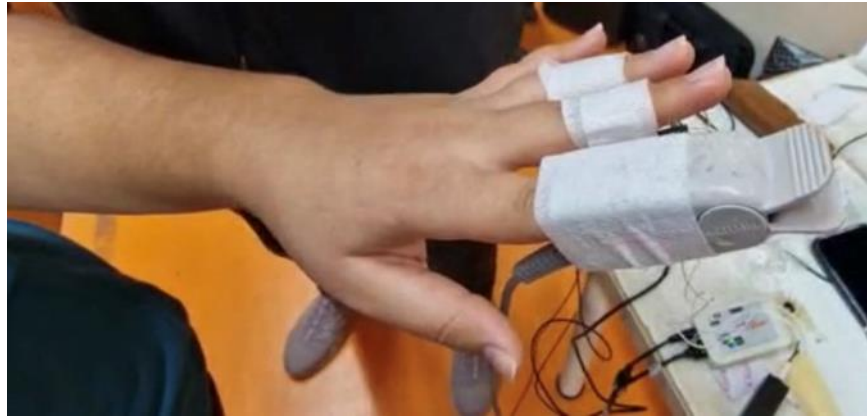
Görsel 3.5. Örnek Cİ sensör ve parmak fotopiletismografi yerleşimi
