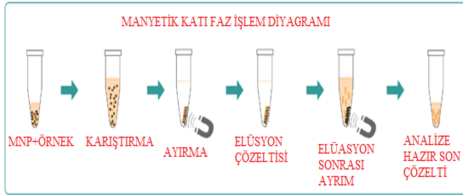
Şekil 3.1: Manyetik katı faz ekstraksiyonu yöntemi (Meszaros 2021)
