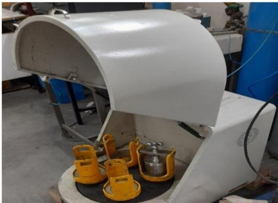
Şekil 3.2 Gezegen bilyalı öğütücü ile öğütme ve MA işlemi
