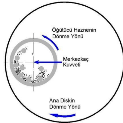
Şekil 3.2 Gezegen bilyalı öğütücü ile öğütme ve MA işlemi
