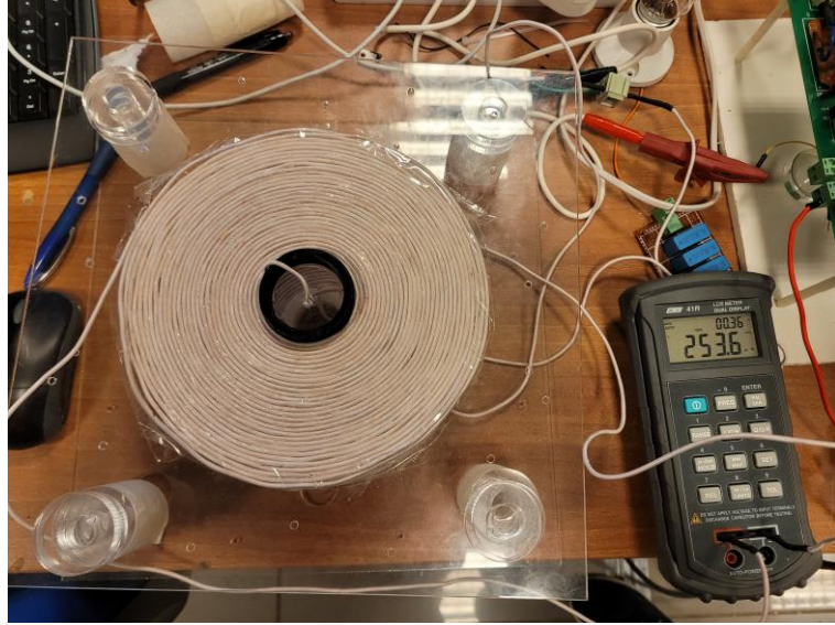
Şekil 4.10 Ortak endüktans değerinin bulunması
