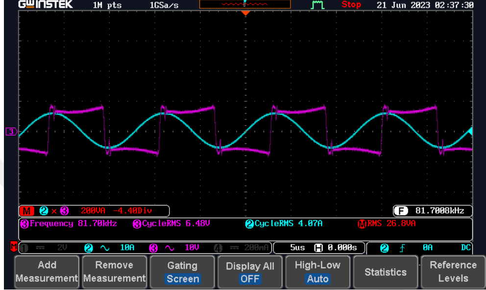
Şekil 4.17 Verici tarafın elektriksel değerleri (8 VDC)
