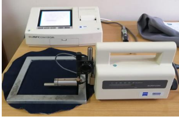
Şekil 3.2. Accretech Surfcom 130 A Yüzey Pürüzlülüğü Ölçüm Cihazı
