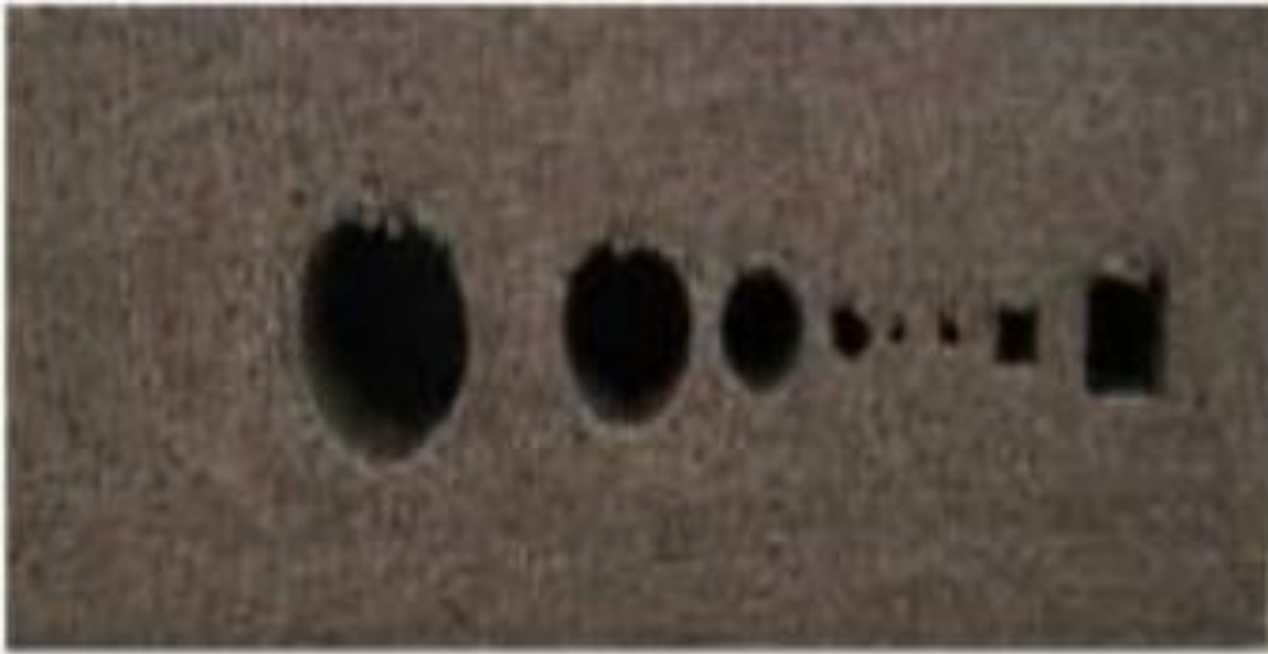
Resim 4.20. Wang ve arkadaşlarının imal yönüne dik yönde ürettiği delik unsurlar [77]
