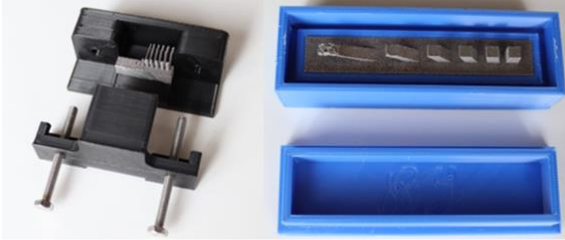
Resim 3.7. İmal edilen ürünlerin kırılmaması için yapılan taşıma kutuları
