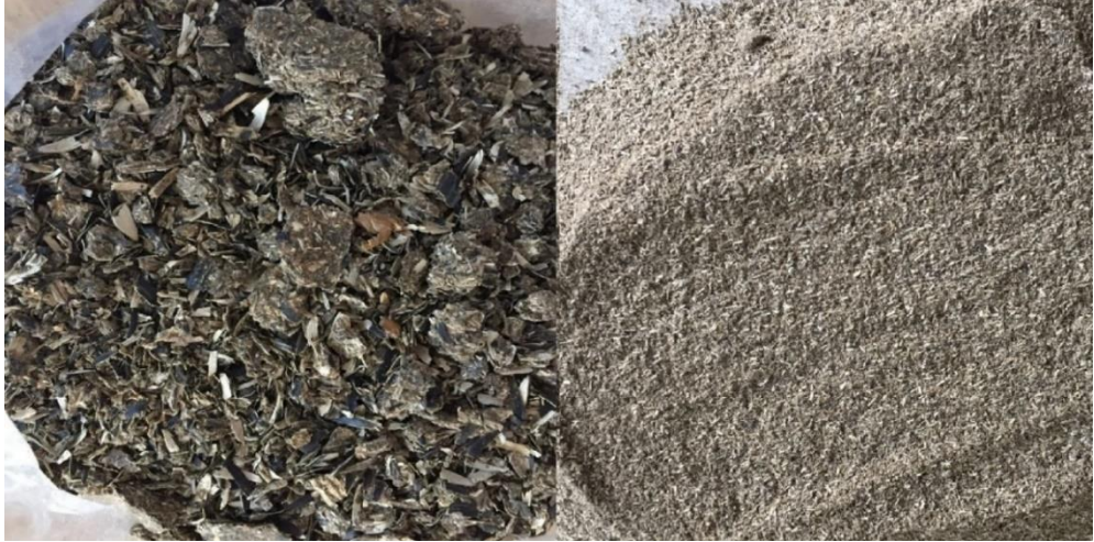
Şekil 3.1 : Ayçiçeği yağı küspesi ve yağsızlaştırılıp öğütülmüş hali.
