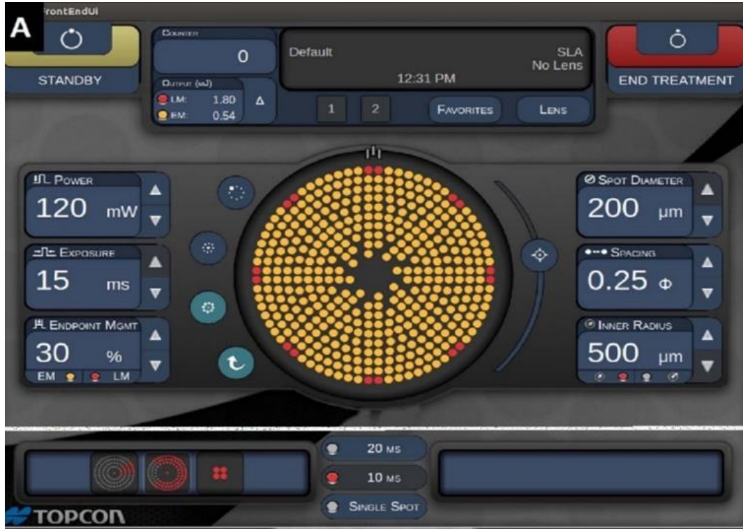
Şekil 10: Pascal cihazında EpM uygulamasının ekran görüntüsü ve başlangıç parametreleri
