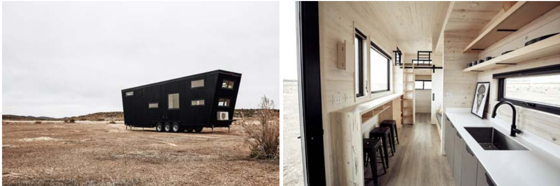
Şekil 5.22: Drake'in siyah metal levha dış cephe kaplaması (solda), ahşap iç cephe kaplaması (sağda) (McKnight, 2018).
