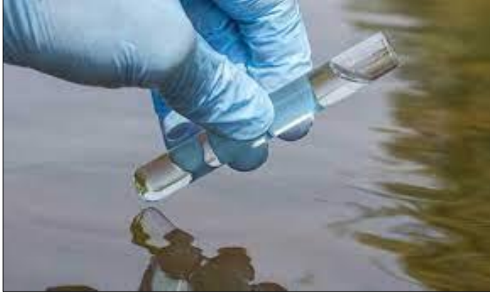
Şekil 2.4. Anlık (Grab) Numune Alımı (Anonim 2)
