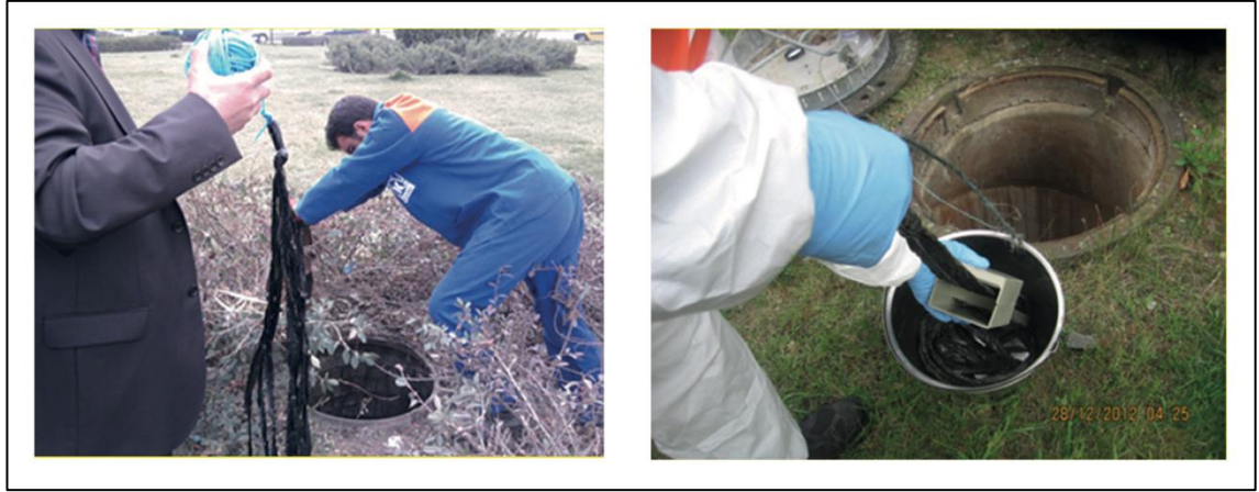
Şekil 2.1. Söz konusu çalışmada kullanılan biyofilm örnekleyici ahtapot (Bedük vd., 2021)
