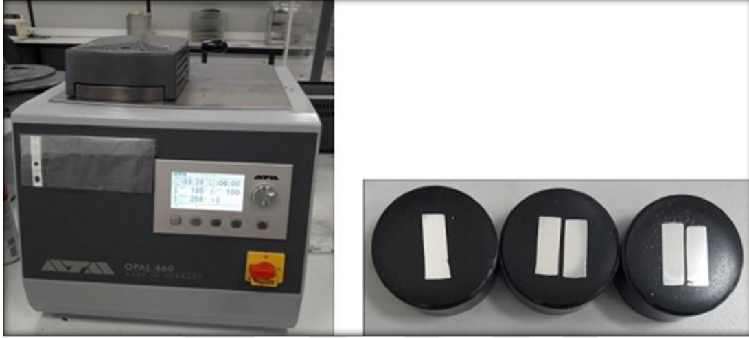
Resim 6.5. Bakalite alma cihazı ve bakalite alınmış incelenmeye hazır numuneler
