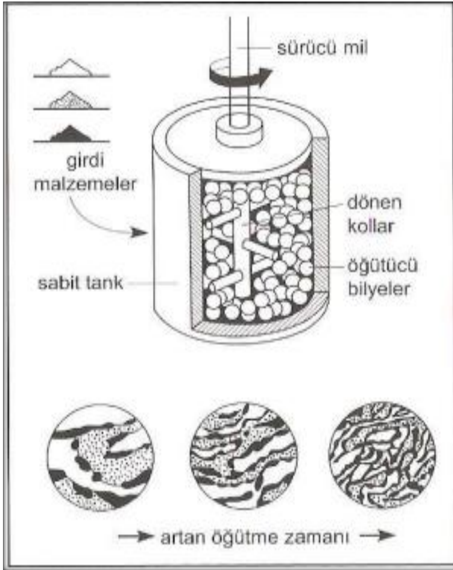
Şekil 4.3. Mekanik alaşımlama işlemi [51]
