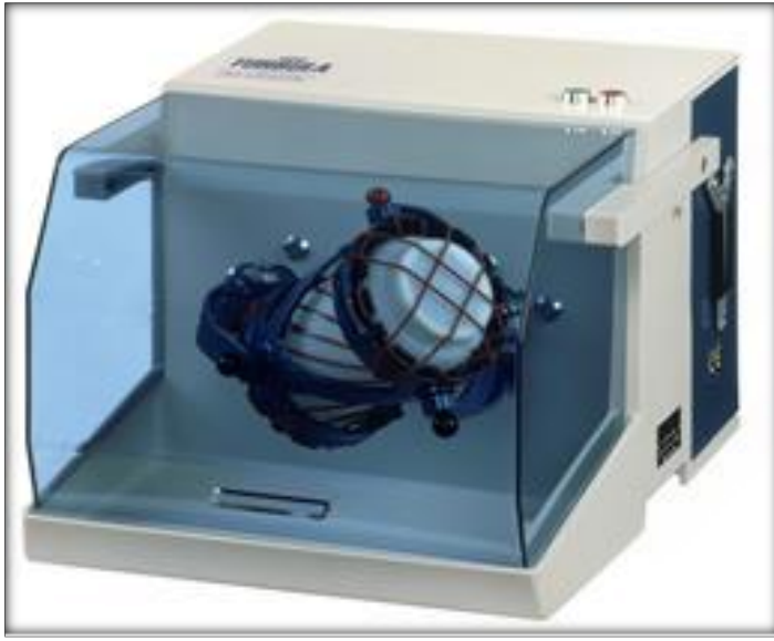
Resim 6.1. Karıştırma - öğütme yapılan turbula (Type-T2F) cihazı
