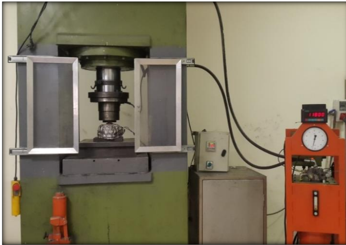
Resim 6.3. Sıcak Presleme yapılan hidrolik pres
