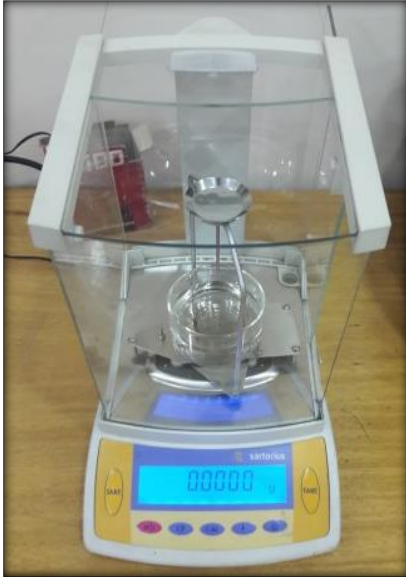
Resim 6.8. SARTORIUS marka yoğunluk kiti yerleştirilmiş hassas terazi
