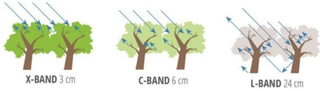
Şekil 3.9 SAR Uydu bantları penetrasyon özellikleri (Anonim, 2023b)
