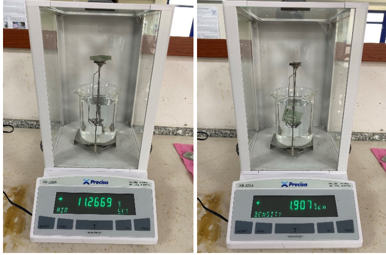
Şekil 3.6. Yoğunluk ölçer cihazında kompozit yoğunluğu ölçümü.
