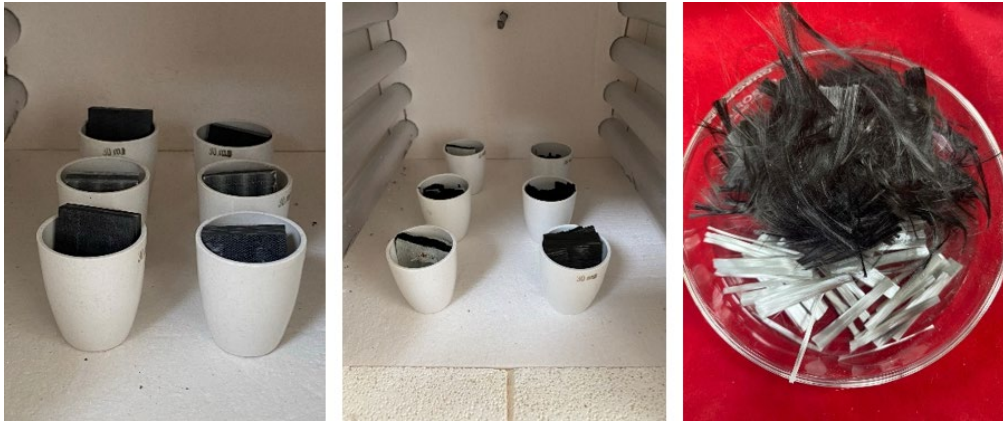
Şekil 3.7. Kül fırınında lif miktarı tayini.
