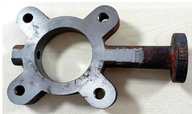
Şekil 2.17 : 20 mm inceltilmiş vana gövdesi.
