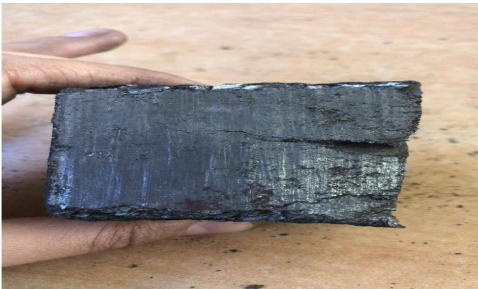
Şekil 3.12 : 300 ton ve 25°C’de preslenmiş SDD talaşları.
