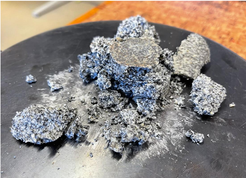
Şekil 4.7 : A1 numunesinin basma hasarına uğraması.
