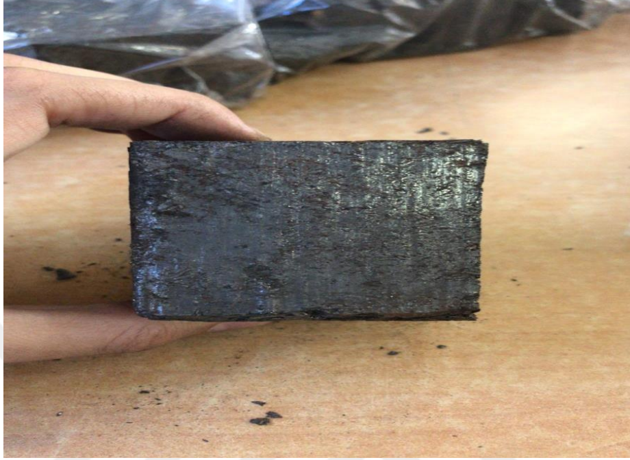
Şekil 3.13 : 500 ton ve 25°C’de preslenmiş SDD talaşları.
