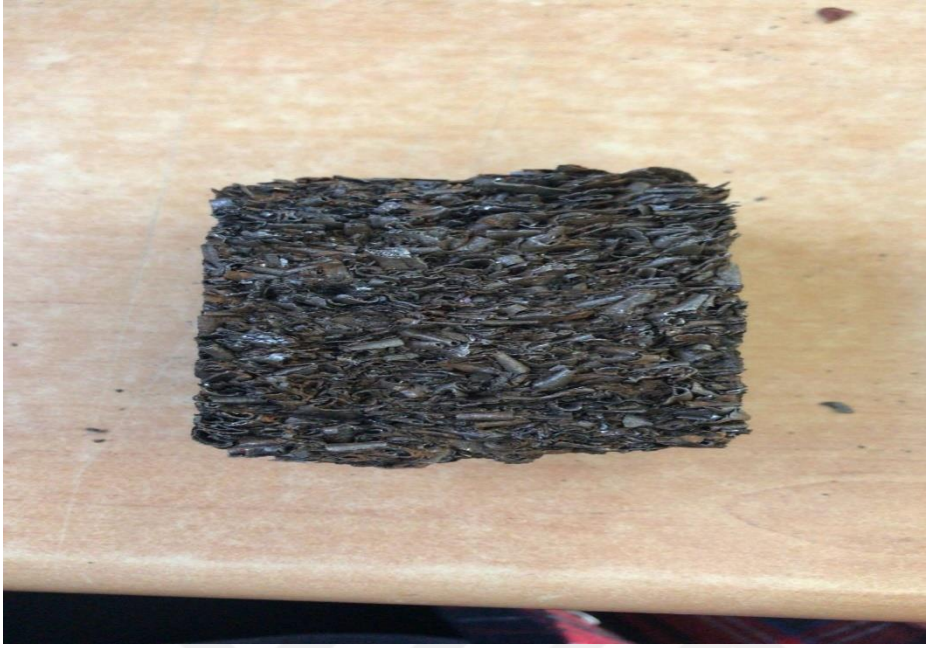
Şekil 3.11 : 100 ton ve 25°C’de preslenmiş SDD talaşları.
