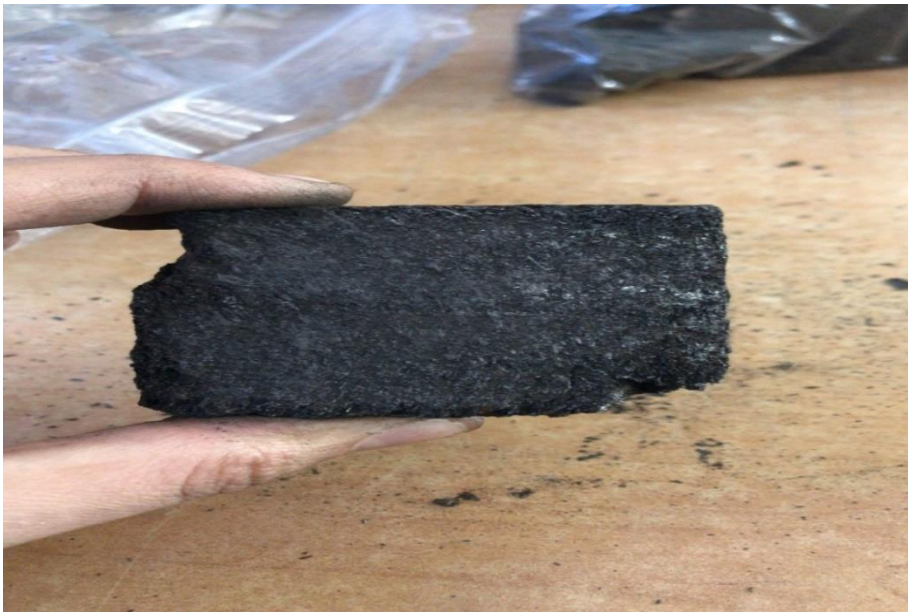
Şekil 3.9 : 500 ton ve 25°C’de preslenmiş PDD talaşları.
