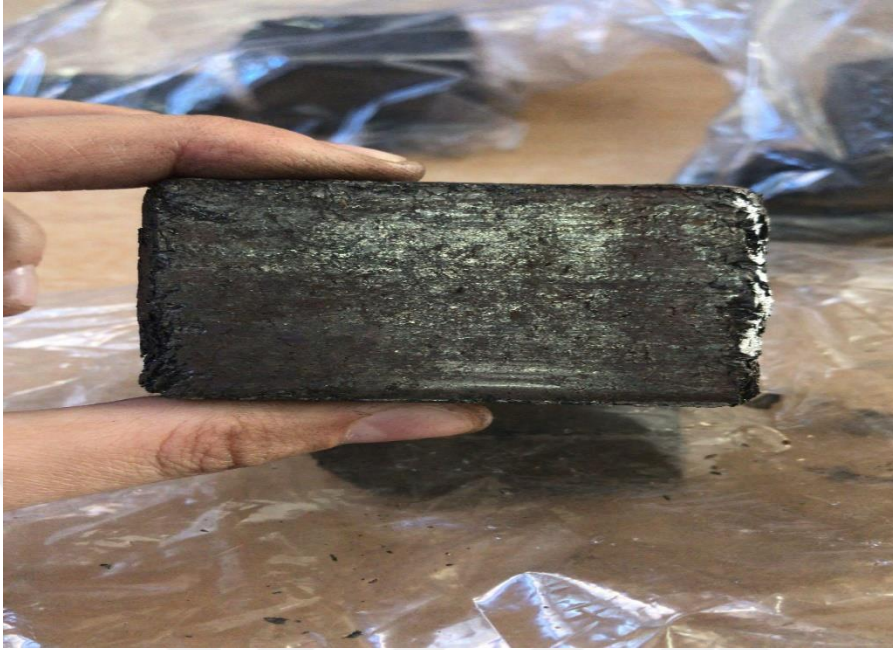
Şekil 3.14 : 300 ton ve 260°C’de preslenmiş SDD talaşları.
