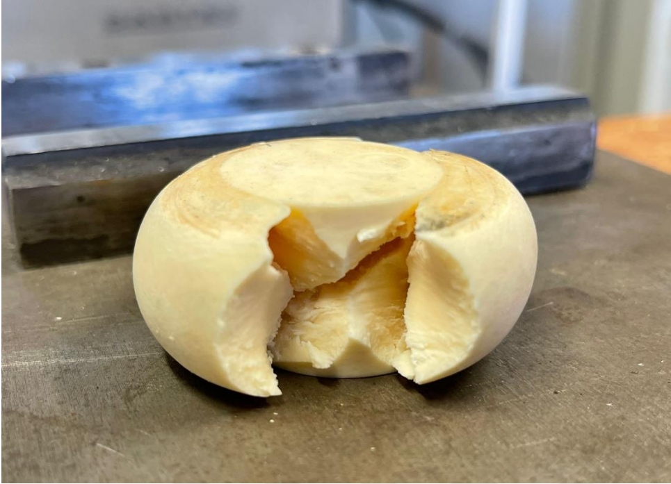
Şekil 4.3 : C1 numunesinin basma hasarına uğraması.
