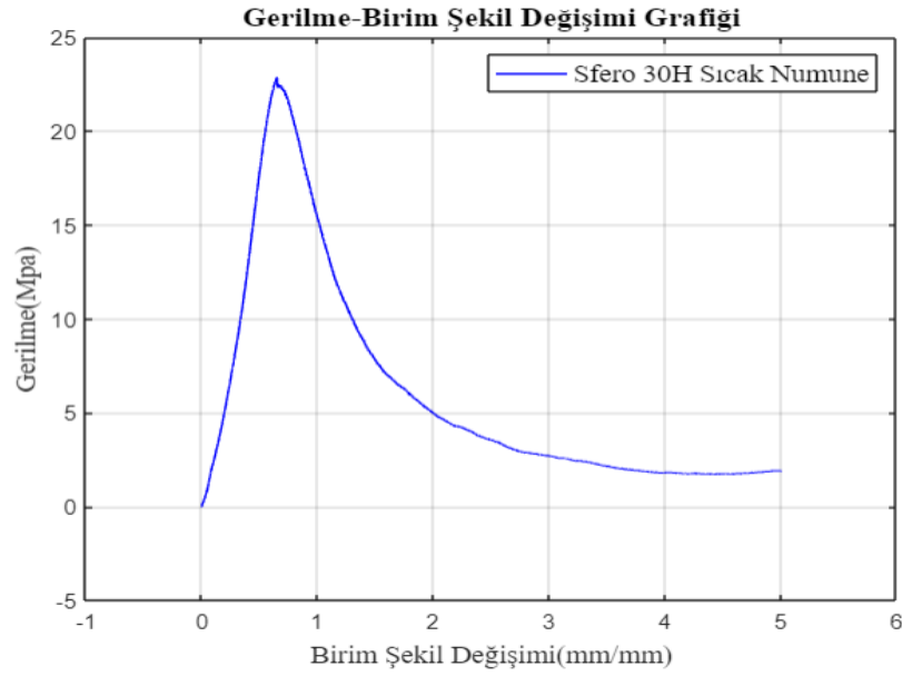
Şekil 4.13 : SDD 300 ton sıcak numune basma grafiği.
