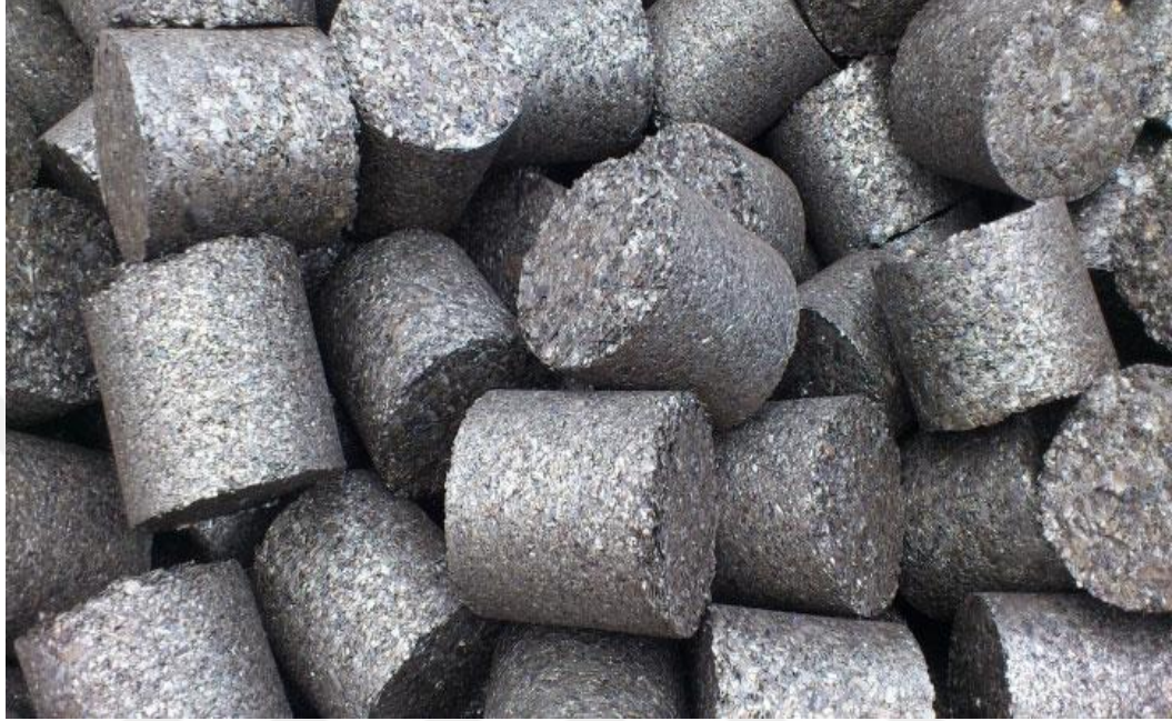
Şekil 3.2 : Briketlenmiş dökme demir örnekleri [32].
