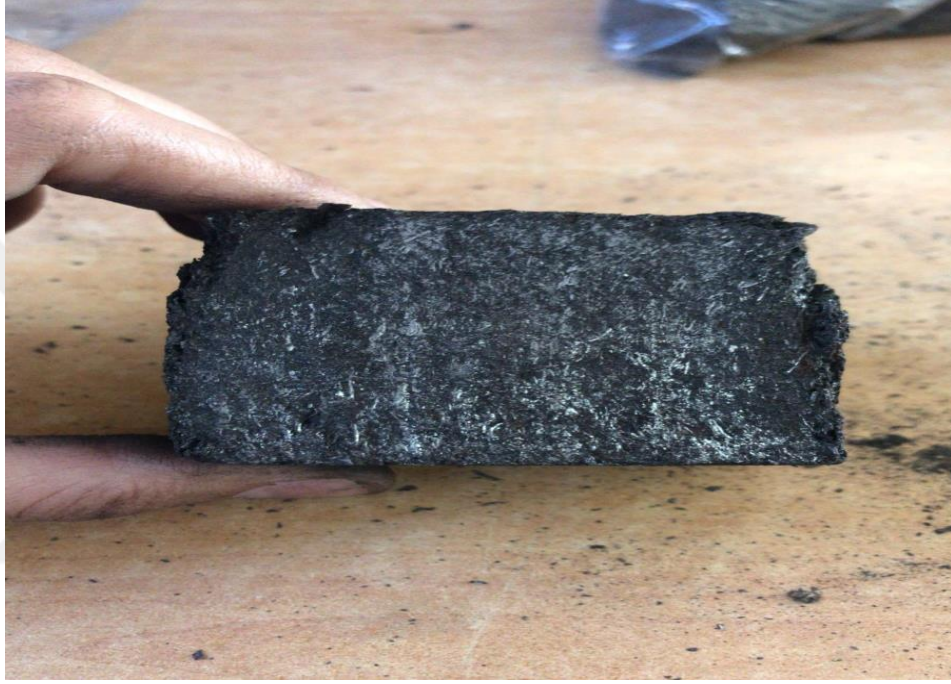
Şekil 3.10: 300 ton ve 260°C’de preslenmiş PDD talaşları.
