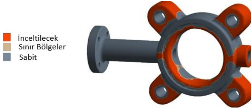
Şekil 2.14 : Mevcut tasarımda %40 kütle azaltılacak bölgeler.
