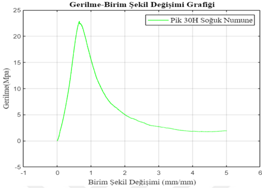
Şekil 4.11 : PDD 300 ton soğuk numune basma grafiği.
