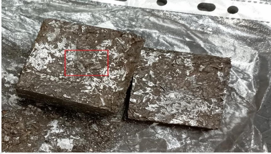
Şekil 3.18: SDD talaşlarının testere ile kesilmesi.
