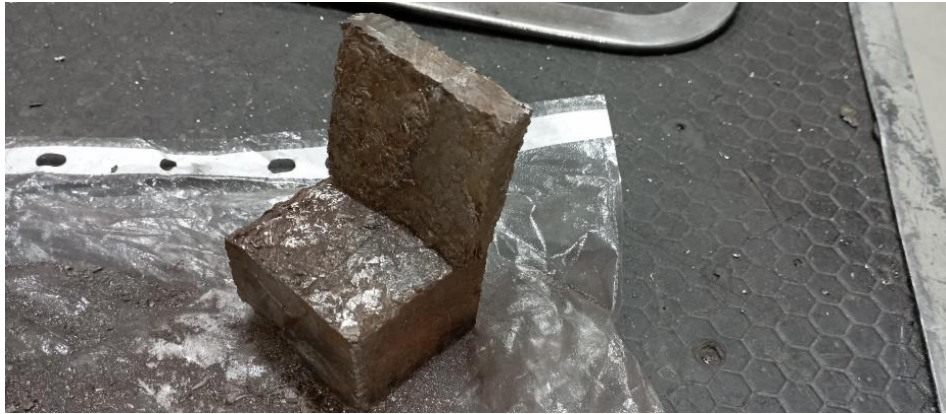
Şekil 3.19: Mengenede parçalanmış SDD talaş numunesi.
