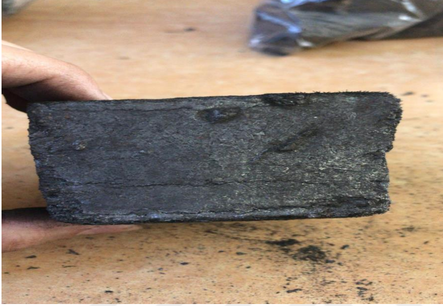
Şekil 3.8 : 300 ton ve 25°C’de preslenmiş PDD talaşları.
