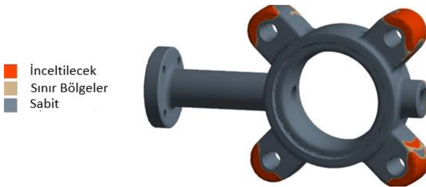
Şekil 2.13 : Mevcut tasarımda %20 kütle azaltılacak bölgeler.
