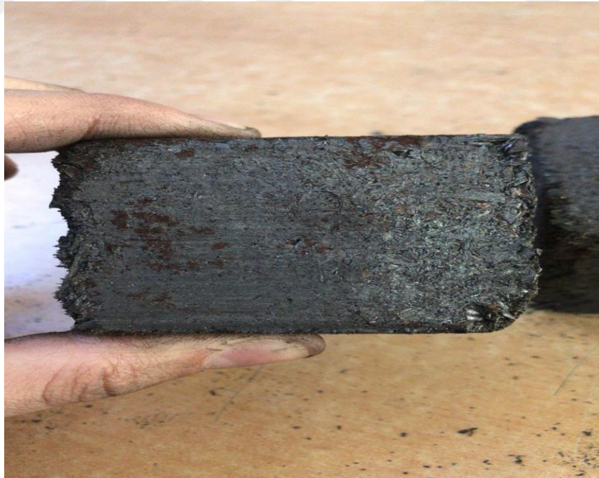
Şekil 3.7 : 100 ton ve 25°C’de preslenmiş PDD talaşları.
