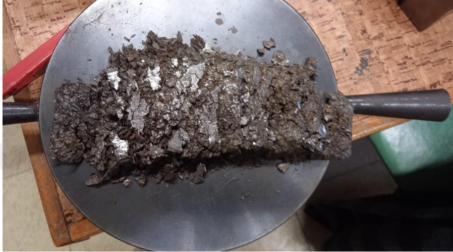
Şekil 4.9 : 100 ton ile preslenmiş SDD ve PDD numuneler.
