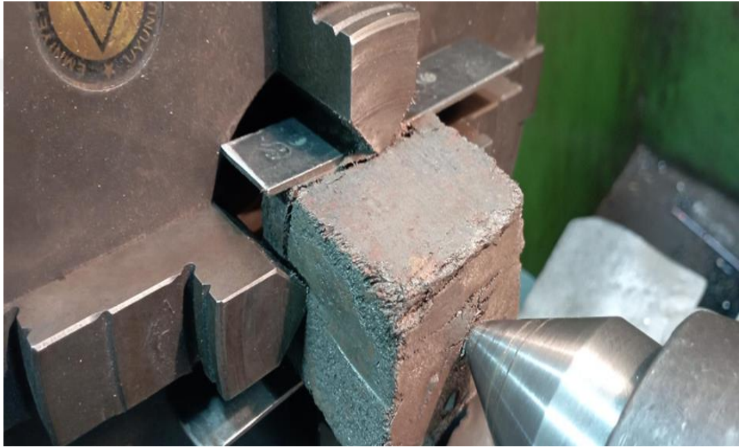
Şekil 3.16 : 300 ton 260°C’de preslenmiş PDD talaşlarının işlenmesi.
