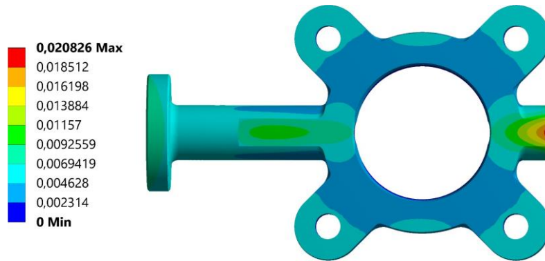
Şekil 2.15 : Optimize edilmiş gövde üzerindeki deformasyon dağılımı.
