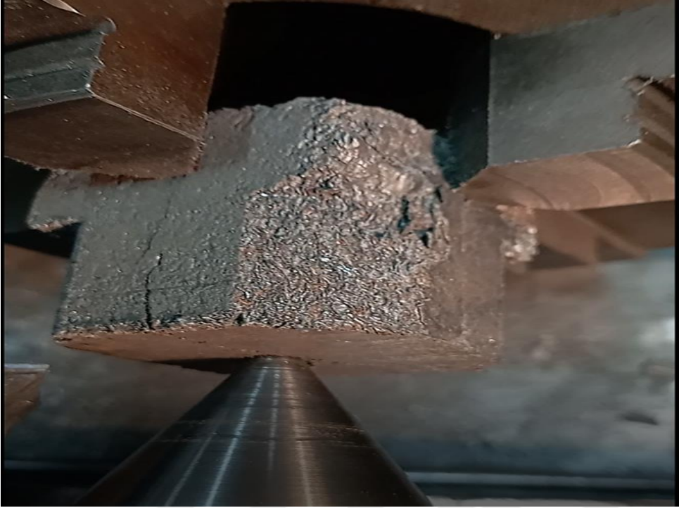
Şekil 3.17 : 300 ton 260°C’de preslenmiş SDD talaşlarının işlenmesi.
