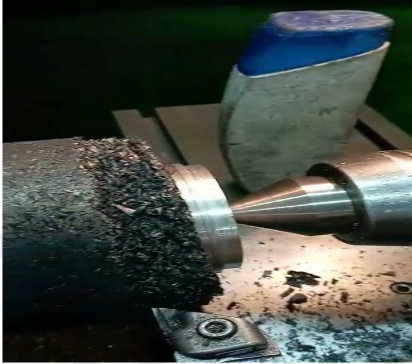
řekil 3.6 : Briket numunesinin talařlı iřlenmesi.
