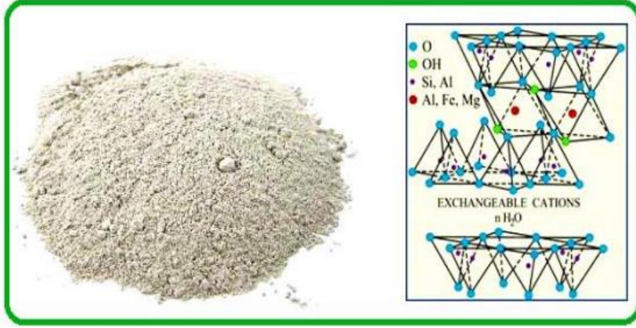
Şekil 2.8 Bentonit kilinin yapısı [39]
