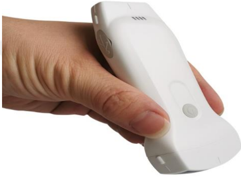
Şekil 3.2. Görüntüleme ve ölçümlerde kullanılan çift problu el tipi ultrason tarayıcısı
