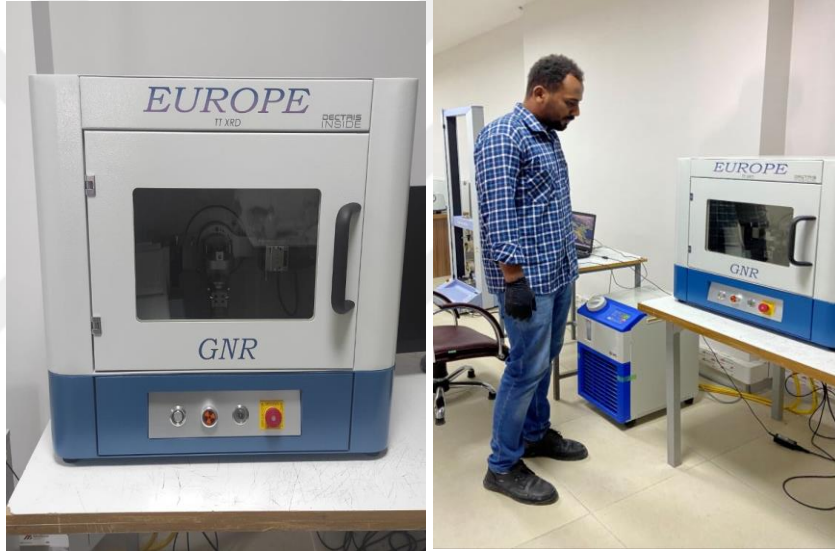
Şekil 3.22. XRD cihazı ve analize ait görüntüler.
