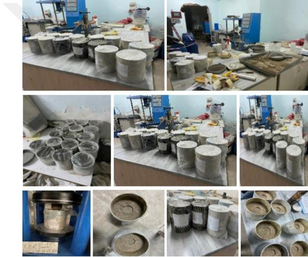
Şekil 3.14. CBR numunelerinin hazırlanmasının görünümü
