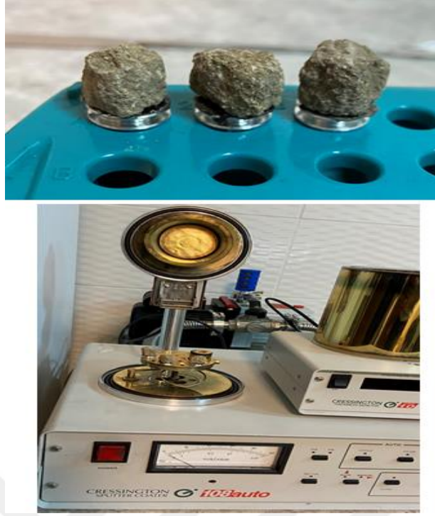
Şekil 3.17. SEM analizi için seçilen numuneler
