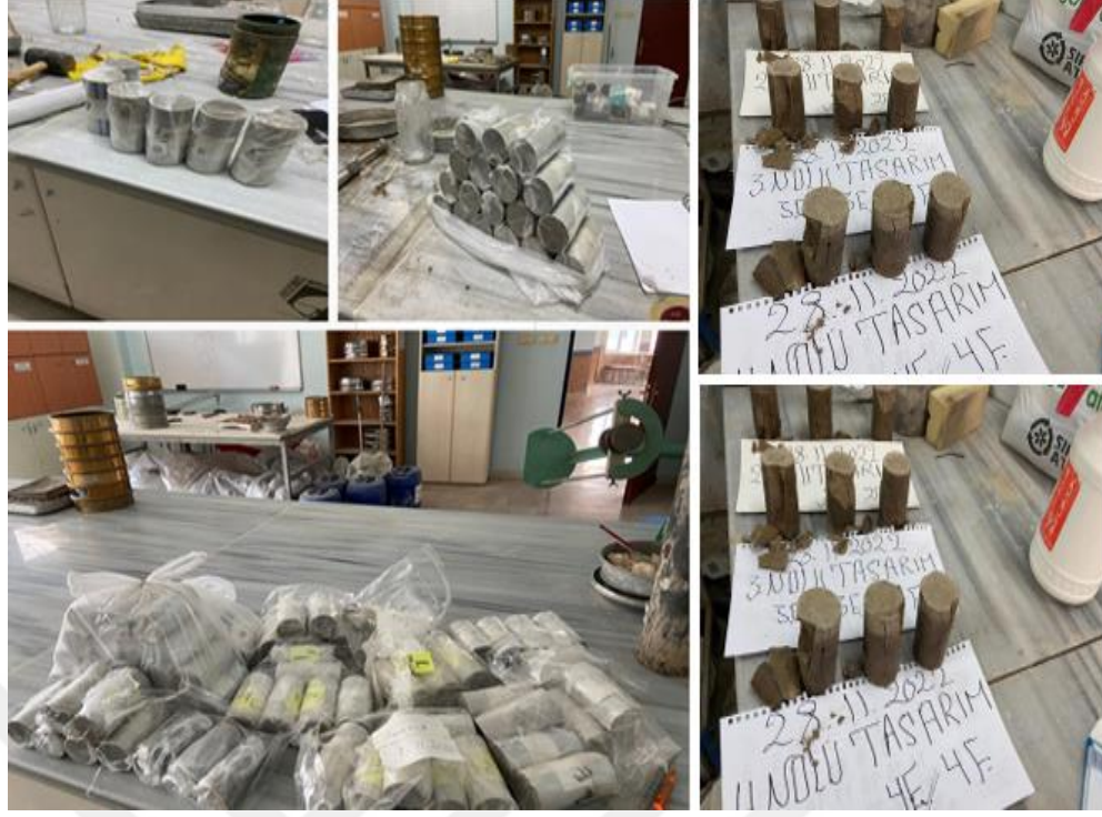
Şekil 3.13. Serbest basınç numunelerinin plastik torbalarda saklanması
