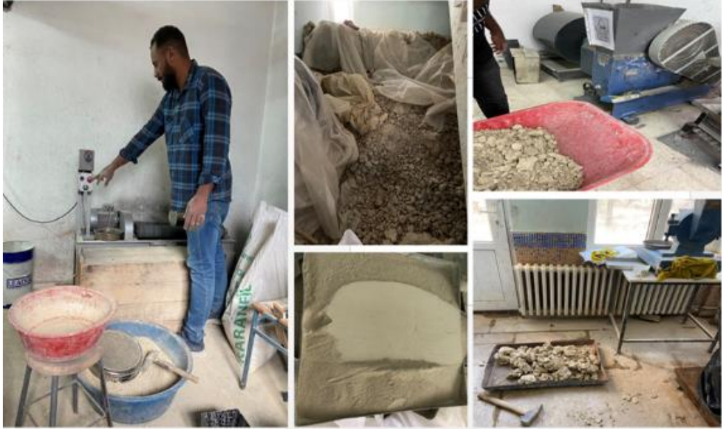
Şekil 3.5. Zemin öğütme ve hazırlama işlemleri
