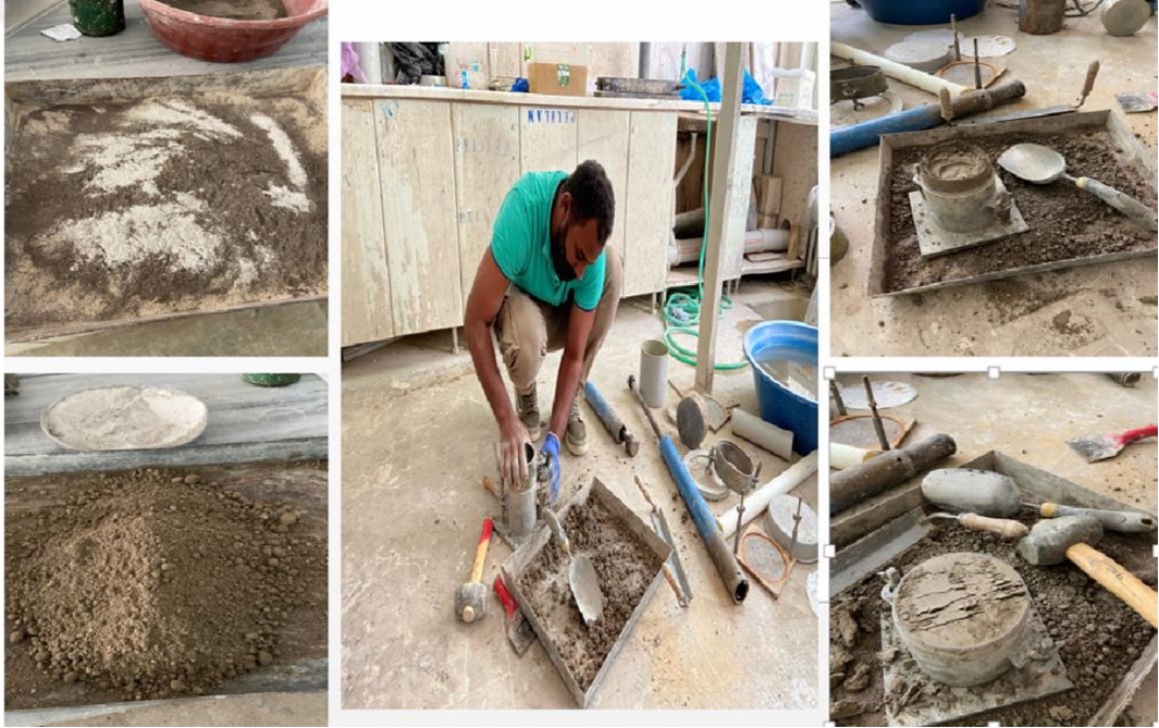
Şekil 3.9. Kompaksiyon deneyin yapılması
