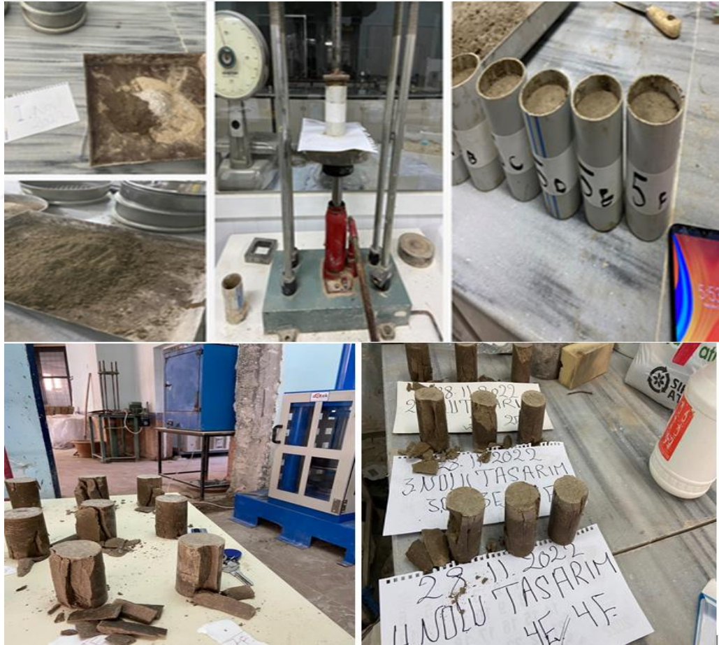
Şekil 3.12. Serbest basınç numunelerinin hazırlanmasının görünümü
