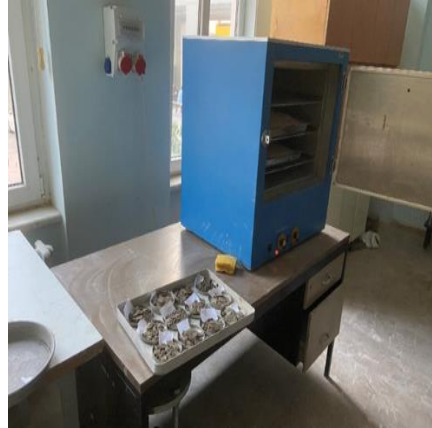
Şekil 3.10. Numunelerin etüvde kurutulması
