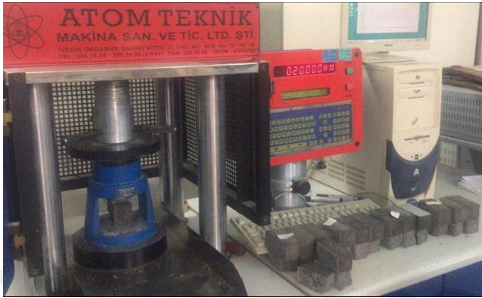
Şekil 3.14. Basınç dayanımı testi
