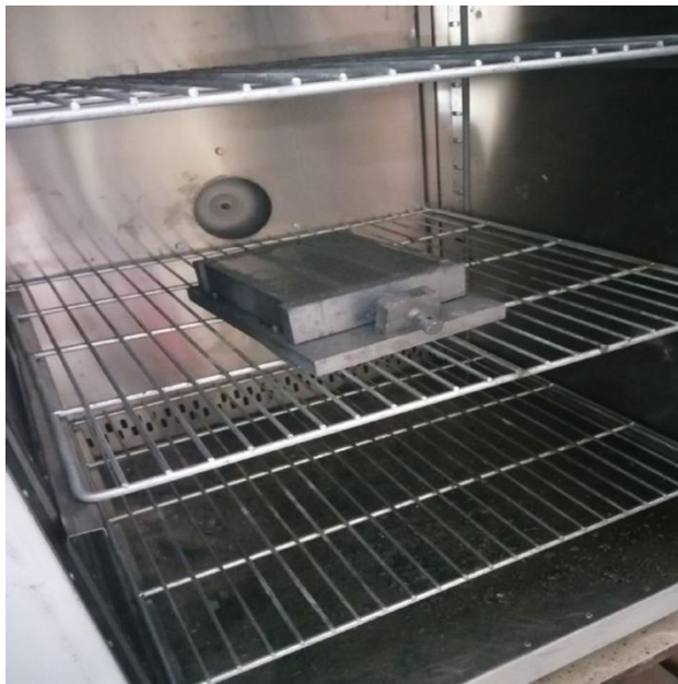
Şekil 3.10. Etüvde kür uygulaması
