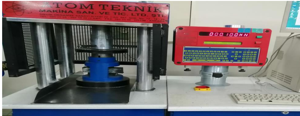
Şekil 3.15. Eğilme dayanımı testi
