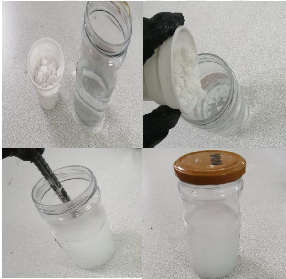
Şekil 3.6. NaOH çözeltisi hazırlanması
