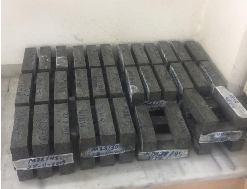
Şekil 3.12. Numunelerin Havada kürlenmesi
