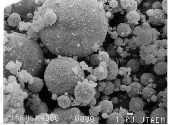
Şekil 3.4. 2000 büyütmede uçucu kül [31]
