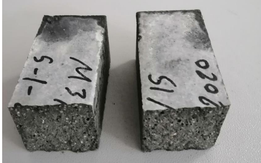
Şekil 4.1. Basınç dayanım testinde kullanılan örnekler
