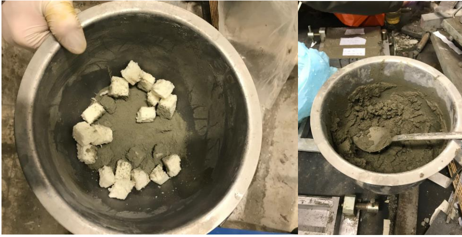
Şekil 3.2 : Atık poliüretan, çimento ve kum ile yapılan referans numunesi.
