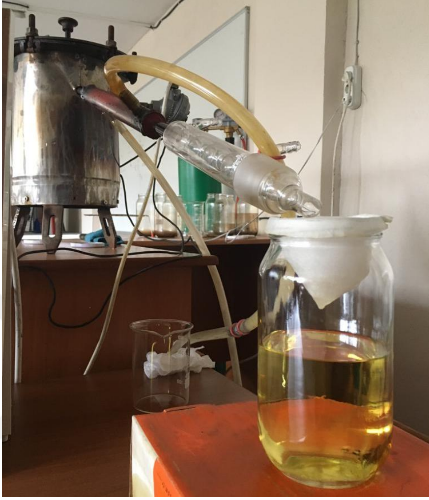
Şekil 7.3. Yakıt üretiminin yapıldığı piroliz düzeneği
