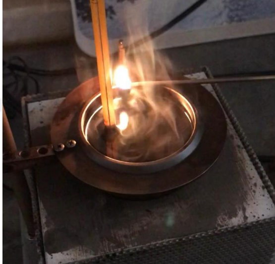
Şekil 3. 23. Parlama noktası deneyi
