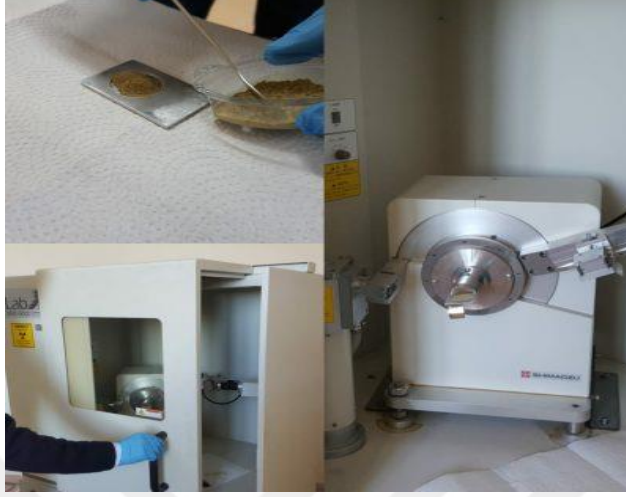
Şekil 3.33. XRD deneyi (AKÜ TUAM, 2020)
