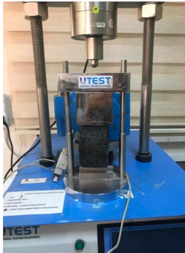
Şekil 3. 29. İndirekt çekme mukavemeti deneyi
