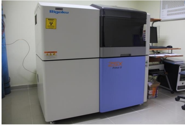
Şekil 3.32. XRF cihazı (AKÜ DAL, 2020)
