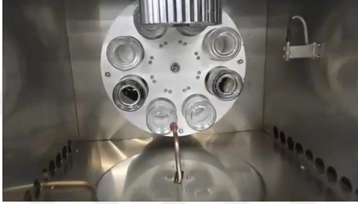
Şekil 3. 25. Dönmeli ince film etüv deneyi
