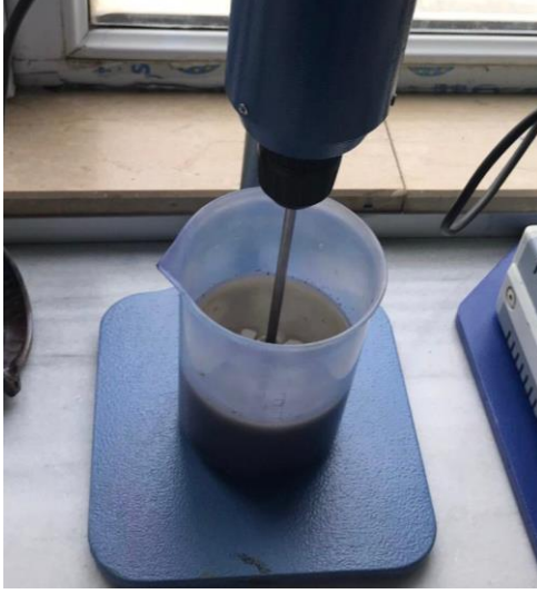
Şekil 3.19. Metilen mavisi deneyi
