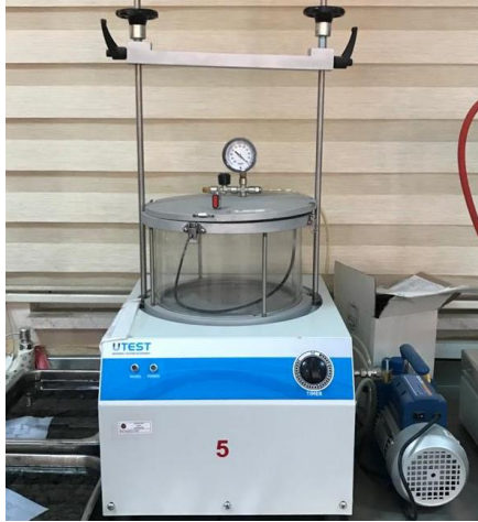
Şekil 3.30. Vakum işlemi için kullanılan cihaz
