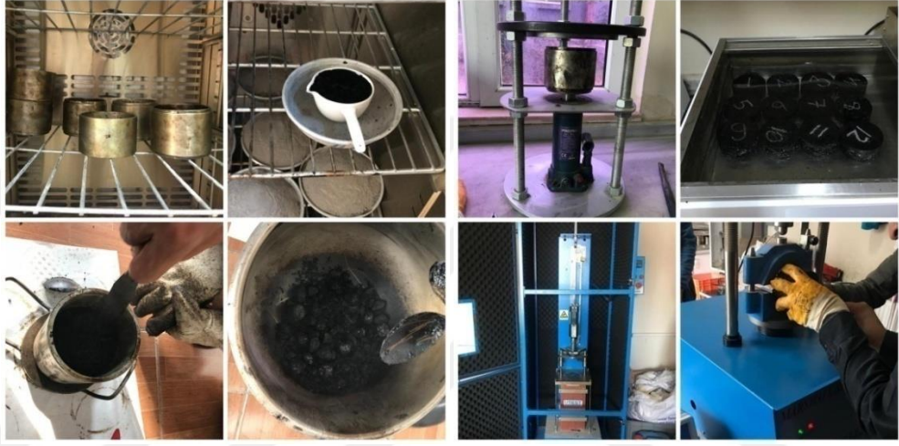
Şekil 3. 26. Marshall deneyi aşamaları
