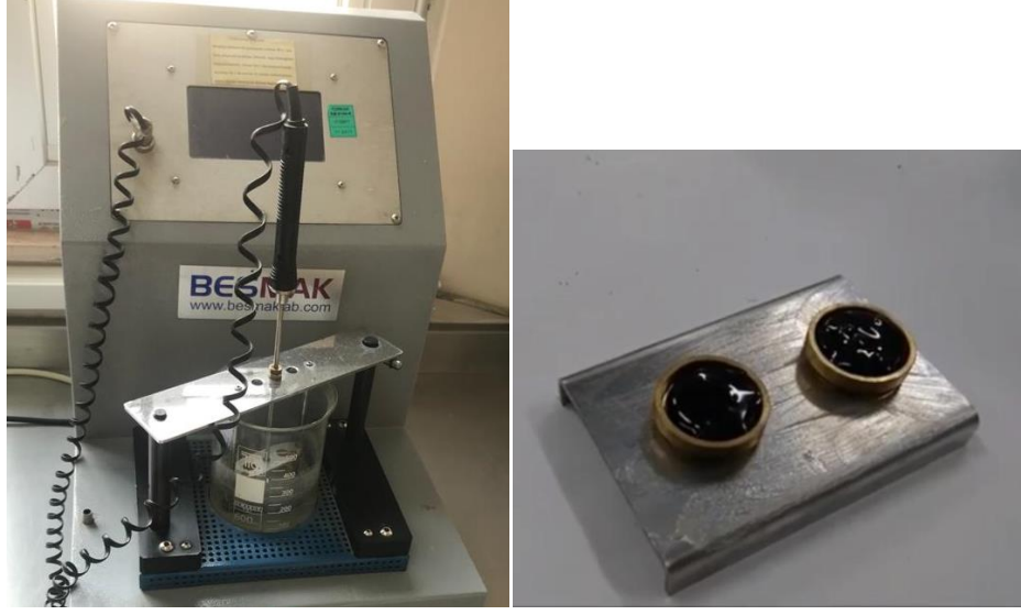
Şekil 3.21. a) Yumuşama noktası deneyi, b) Halkalar
