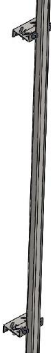
Şekil 4.1 : Kılavuz ray-konsol bağlantısının 5m’lik bir adet örneği
